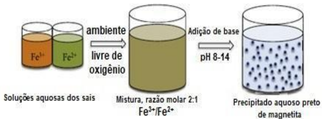
FIGURA 2.4 – Ilustração do método de coprecipitação para síntese de magnetita.
