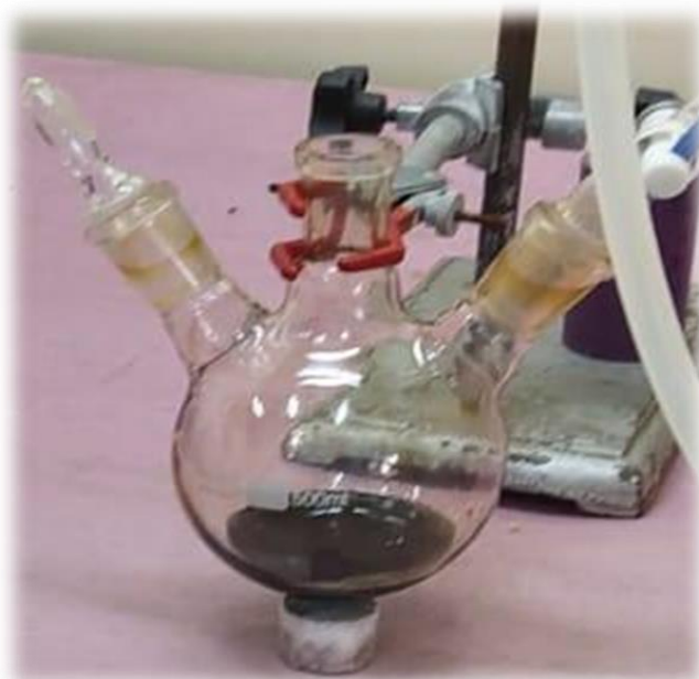
FIGURA 3.5 – Solução organometálica com magnetitas após o processo de decomposição térmica.
