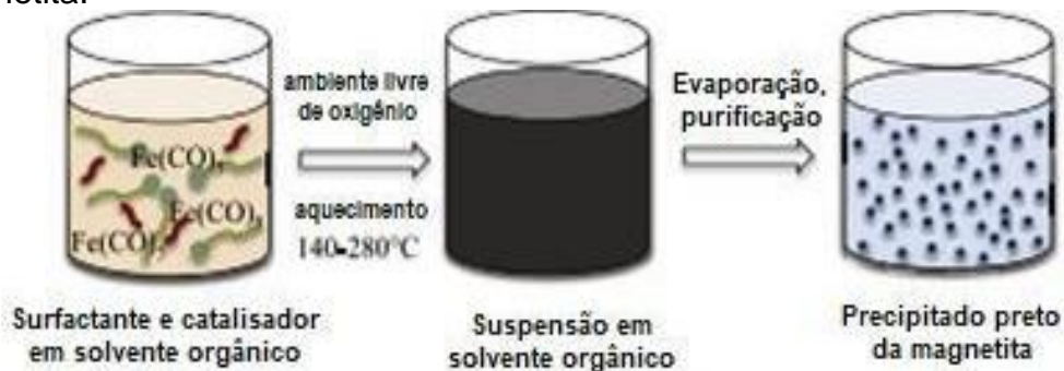
FIGURA 2.5 – Ilustração do método de decomposição térmica para produção de magnetita.
