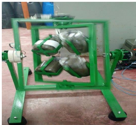
FIGURA 12 – Homogeneizador mecânico de sedimentos do tipo Jar-rolling de duas rotações desenvolvido para realização deste estudo.
