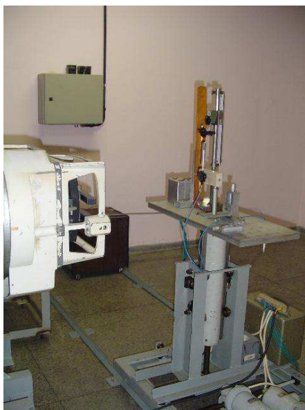
Figura 2.4. Arranjo experimental para calibração em termos de kerma no ar.
