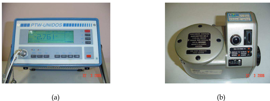
Figura 2.1. a) Eletrômetro utilizado nas calibrações; b) Barômetro utilizado nas calibrações.
