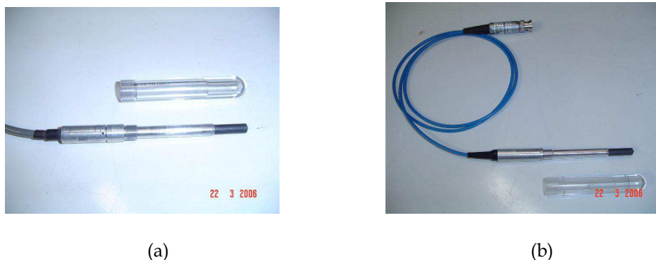
Figura 2.9. a) Padrão #2080 sem a capa de equilíbrio eletrônico; b) Padrão #0272 sem a capa de equilíbrio eletrônico.
