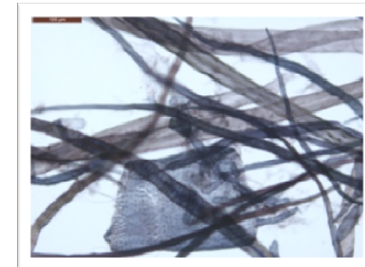
Detalhe da presença de elemento de vaso e pontuação areolada – 200X (acervo da autora)
