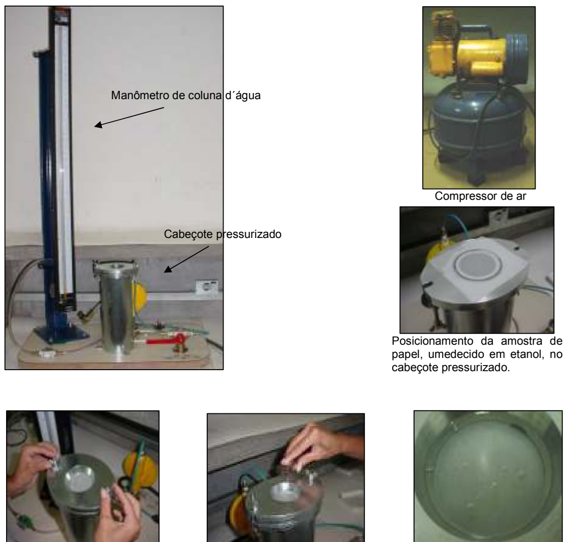
Figura 12 - Porosímetro para determinação do diâmetro de poros, construído pelo IPT e ilustração do modo de realização do ensaio
