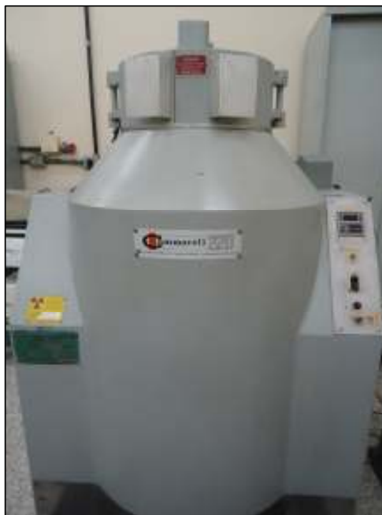
Figura 10 - Irradiador Gammacell 220 série nº 142 (12kCi; 8,5 kGy/h)
