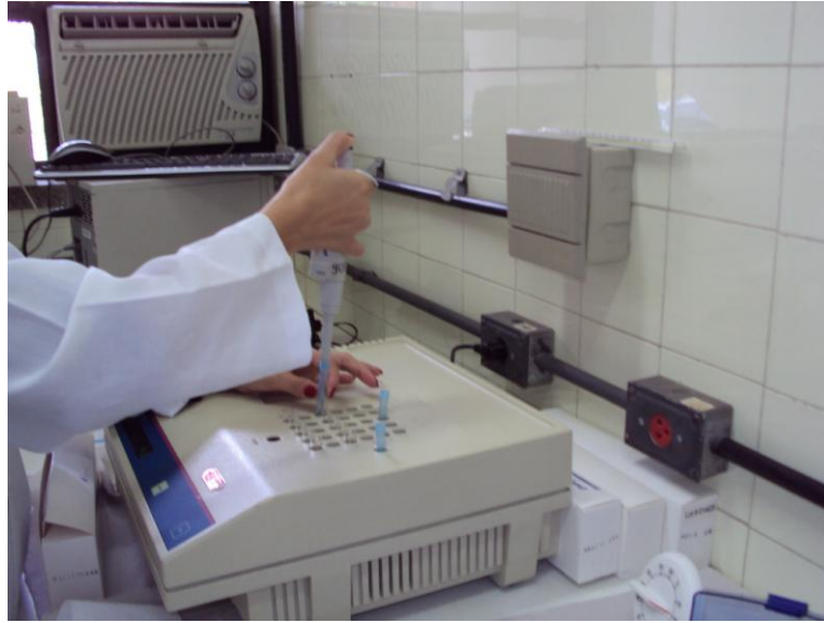
FIGURA 28 – Sistema Microtox utilizado na determinação de bioluminescência da bactéria V. fischeri .
