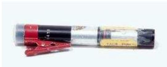
FIGURA 2.2 - Dosímetro de leitura direta (caneta dosimétrica)
