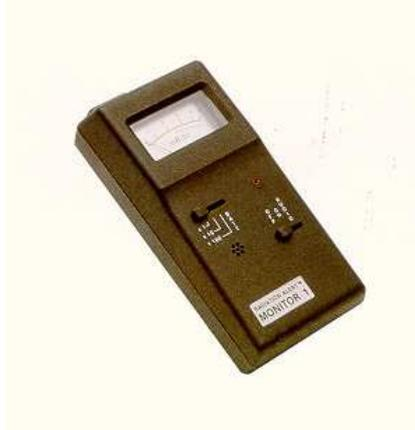
FIGURA 2.4 - Monitor de radiação externa, modelo MC-1K
