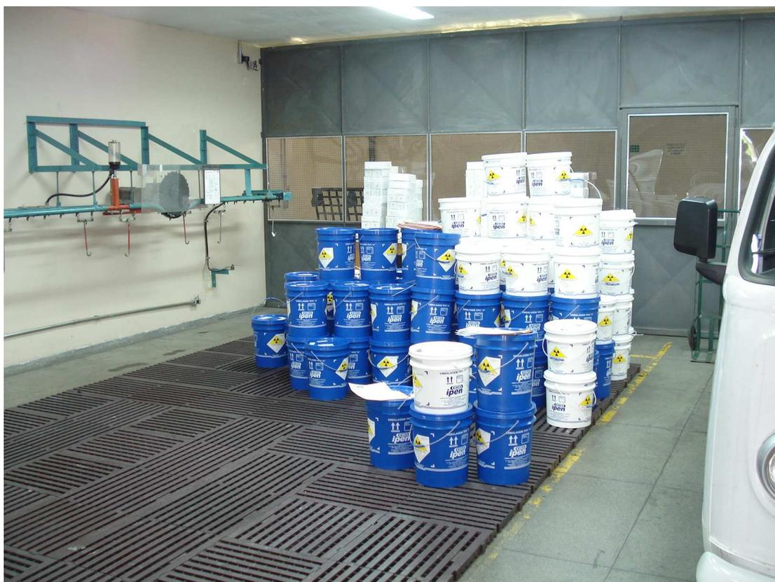
FIGURA 2.6 - Embalados do Tipo A, prontos para o transporte.
