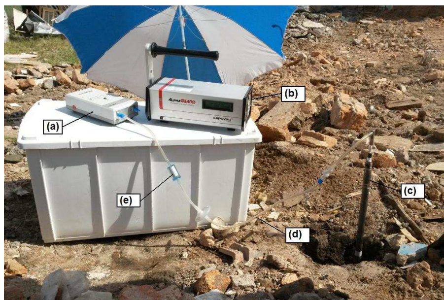
FIGURA 13 – Medida da concentração de radônio no gás do solo do local estudado e seus principais componentes. (a) Alphabomba , (b) AlphaGUARD ® , (c) Sonda, (d) Mangueira e (e) Filtro (Foto, acervo pessoal, 2015).
