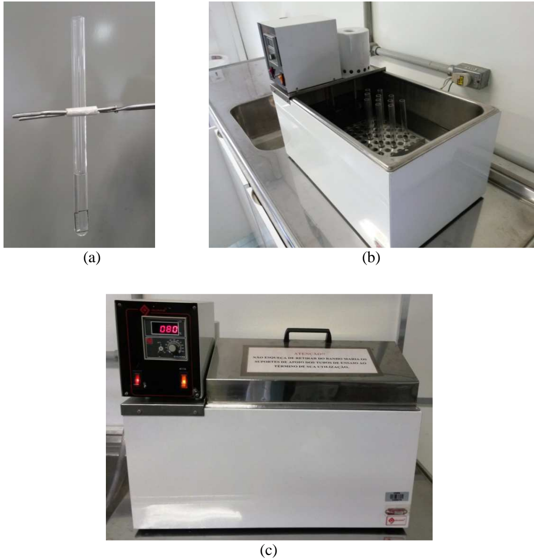
FIGURA 11 – (a) Tubo de ensaio contendo um detector CR-39 em solução de KOH a 30%, (b) Tubos de ensaio dispostos em estante metálica e inseridos em equipamento de banho-maria Quimis, (c) Banho-maria Quimis utilizado para revelação (Fotos acervo pessoal, 2015).
