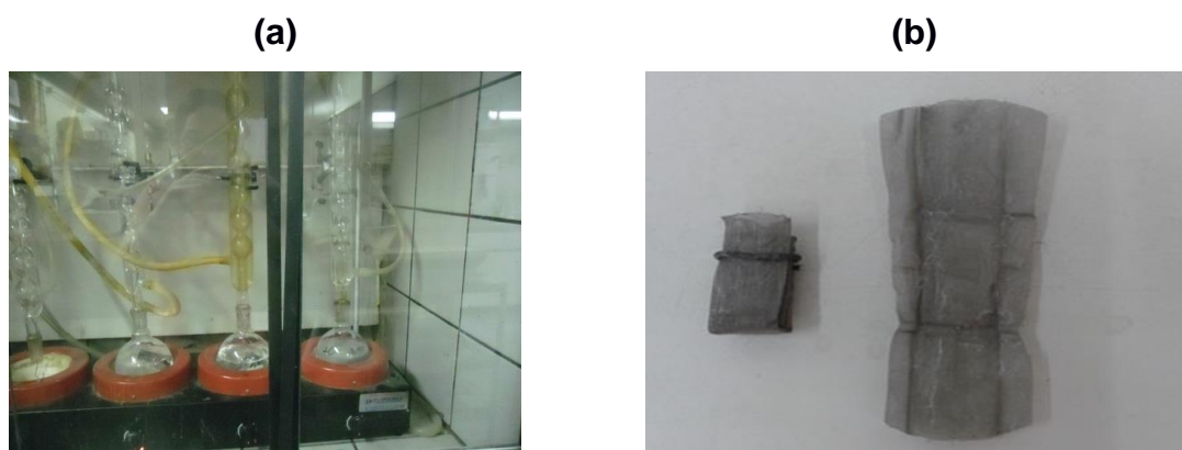
FIGURA 17- Determinação de fração gel. Sistema em refluxo (a); tipo de tela e amostra embalada para a extração (b).
