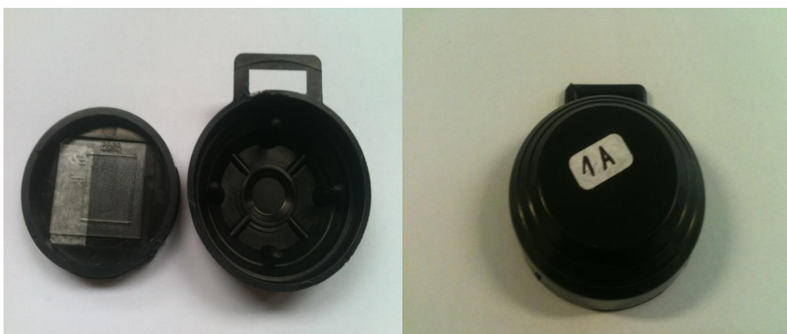
Figura 11. Detector CR-39 inserido em uma câmara de difusão tipo NRPB.
