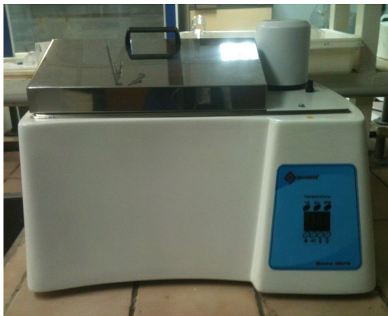
Figura 12. Banho-maria utilizado no processo de revelação dos detectores de traços.
