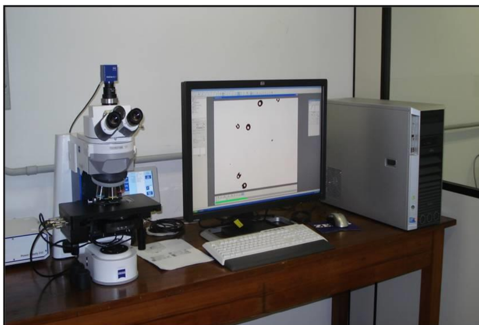
Figura 14. Microscópio óptico ZEISS modelo Axiolab utilizado para leitura da densidade de traços na superfície dos detectores.
