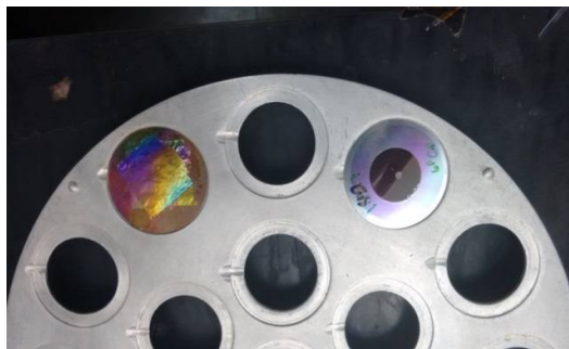
Figura 2.7: Detalhe das fontes radioativas em Collodion, antes e depois da inclusão de absorvedores À direita observa-se uma fonte sem absorvedor e à esquerda observa-se uma amostra com absorvedores.
