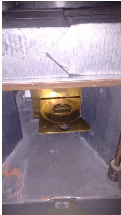
Figura 3.4: Detalhe da lingueta onde é colocada a fonte radioativa no Sistema de Coincidência 4\pi(\text{PC})(\beta, \text{EC})-\gamma instalado no LMN. O detalhe da amostra é mostrado na Figura 2.4.
