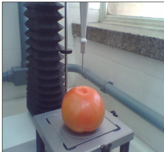
FIGURA 9 – Análise da textura do tomate em um texturômetro, com o probe cilíndrico de 2mm.
