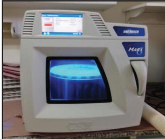
FIGURA 18 - Amostras de sedimento no digestor MARS 6 (CEM Corporation).
