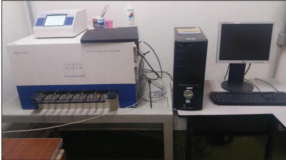
FIGURA 32 - Contador proporcional de fluxo gasoso, Berthold, modelo LB 770/2-5.
