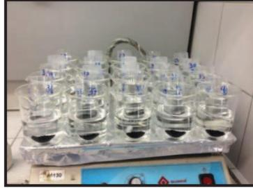
FIGURA 28 - Precipitação do sobrenadante contendo  $^{210}\text{Pb}$  com  $\text{Na}_2\text{S}$ .
