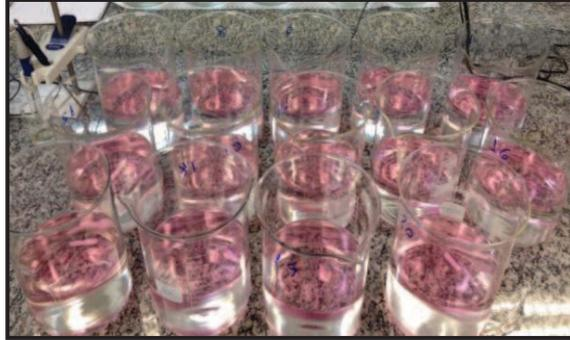
FIGURA 21 - Solução de 1 L com os reagentes necessários a primeira etapa de separação radioquímica.
