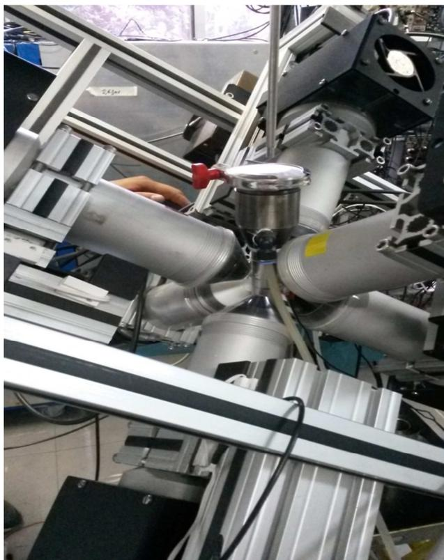
**FIGURA 7: Espectrômetro CAP com 6 detectores de BaF<sub>2</sub> com forno acoplado para medidas a altas temperaturas. Fonte: própria autora.**
