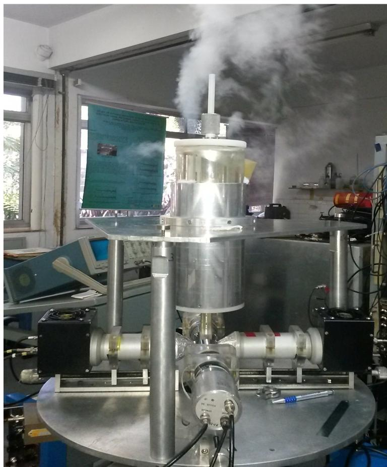
**FIGURA 6:** Espectrômetro CAP com 4 detectores de  $\text{BaF}_2$ . Medida feita a 77K com a amostra selada em quartzo imersa em uma garrafa com nitrogênio líquido. Fonte: própria autora.
