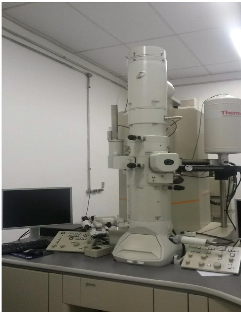
**FIGURA 12:** Foto do equipamento de Microscopia de Transmissão acoplado ao equipamento de Espectrometria de fluorescência de raios-x por dispersão em energia do Centro de Ciência e Tecnologia dos Materiais do IPEN. Fonte: própria autora.
