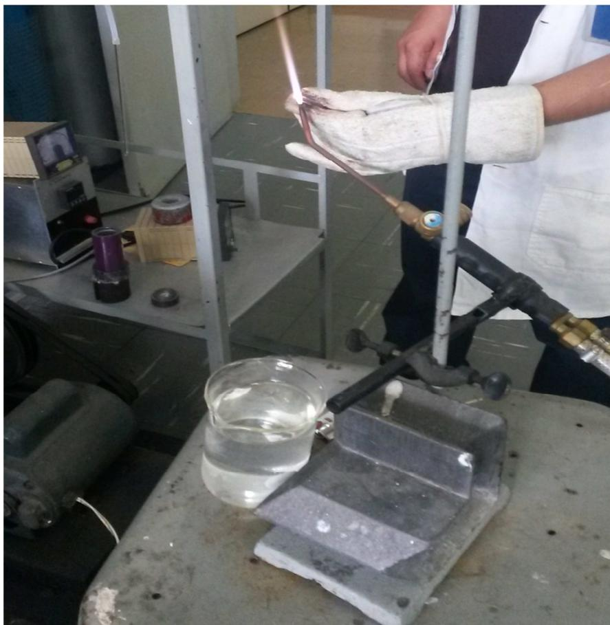
**FIGURA 23: Processo de selagem à vácuo em vidro de quartzo das amostras. Fonte: própria autora.**
