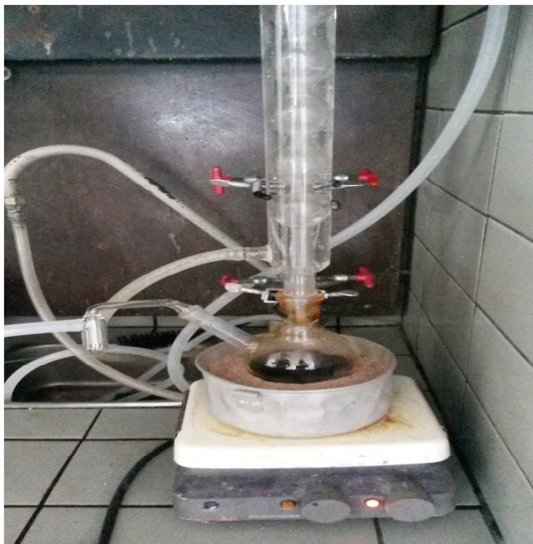
**FIGURA 5:** Síntese de nanopartículas de  $\text{Fe}_3\text{O}_4$  por decomposição térmica com refluxo a 200 graus Celsius em banho de areia (sem sonda radioativa) no Instituto de Química da USP. Fonte: própria autora.
