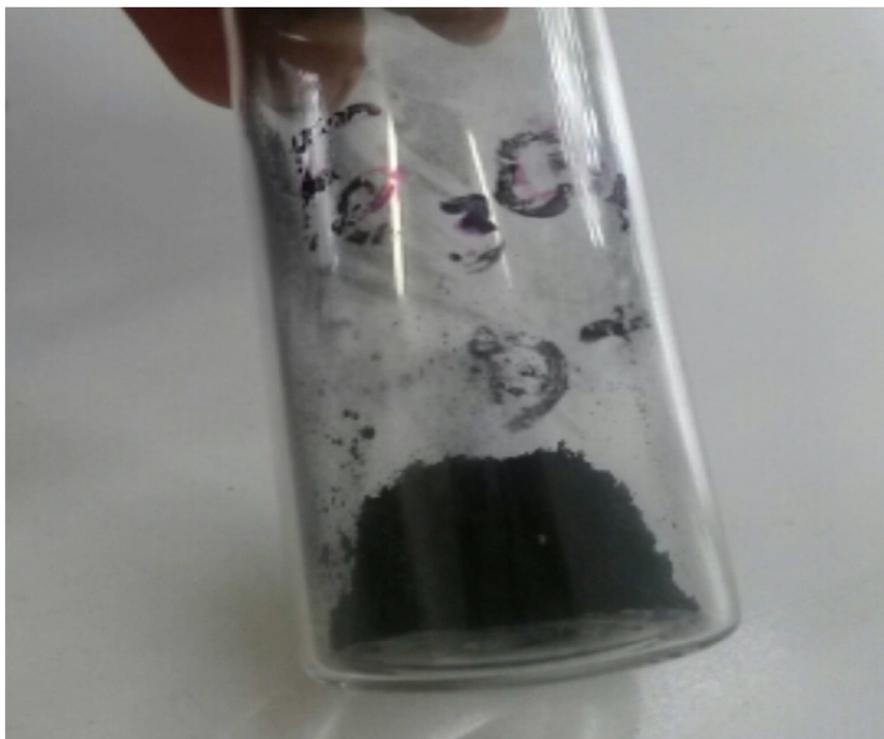
**FIGURA 4:** Amostra SAMP29 de nanopartículas de  $\text{Fe}_3\text{O}_4$  sintetizadas pelo método da decomposição térmica, um pó de coloração preta e de caráter magnético. Fonte: própria autora
