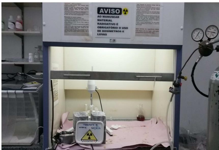
**FIGURA 3:** Síntese de nanopartículas de Fe<sub>3</sub>O<sub>4</sub> pela co-precipitação sob atmosfera inerte contendo a sonda radioativa <sup>111</sup>In e blindagem de chumbo no Laboratório de Interações Hiperfinas-IPEN.
