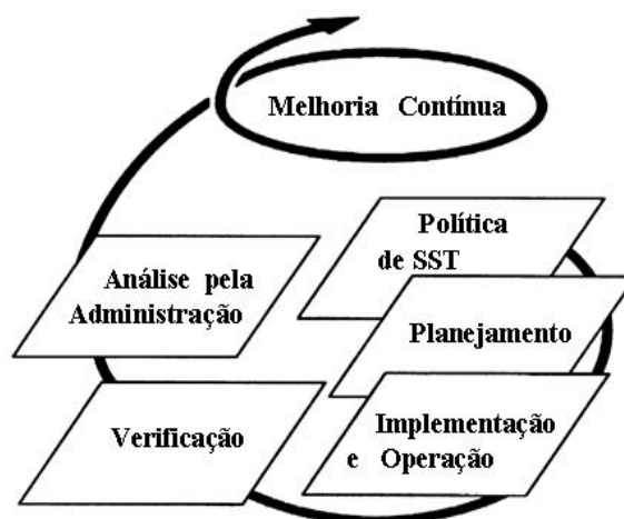
FIGURA 8 – Modelo Representativo de um Sistema de Gestão de Segurança e Saúde no Trabalho – OHSAS 18001.
