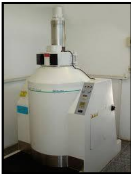
FIGURA 13 - Irradiador de Cobalto-60 usado no experimento
