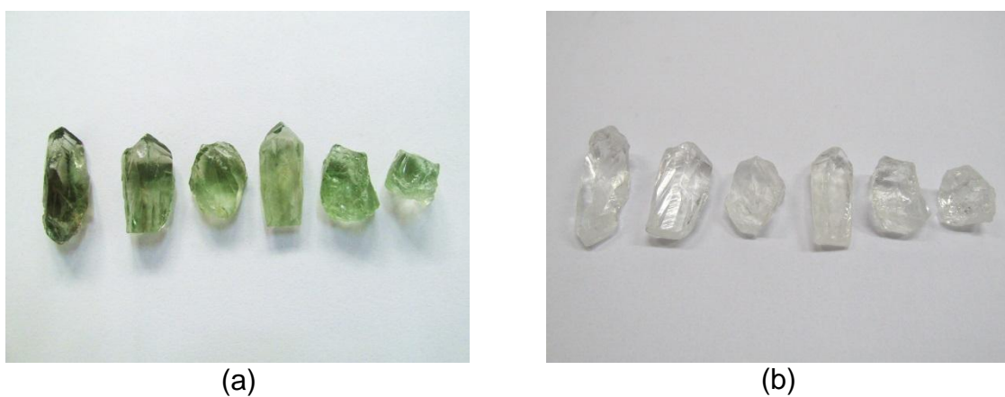
Figura 114 - Amostras de quartzo de Artigas agrupadas de 1 a 6, antes do aquecimento (a) e após o aquecimento (b), a temperatura de 200 °C.
