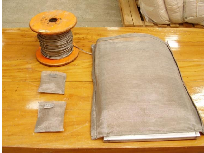
FIGURA 31 - Dispositivo em aço inoxidável AISI 304 para a irradiação de quartzo no fundo da piscina do irradiador multipropósito.
