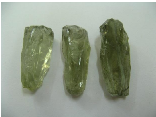
Figura 103 - Quartzo verde claro, médio e intenso de Quarai, antes da exposição UV.
