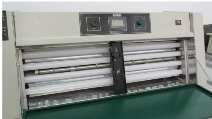
FIGURA 45 - Câmara de envelhecimento acelerado EQUILAM mostrando as placas de Al na parte inferior com as amostras de quartzo.
