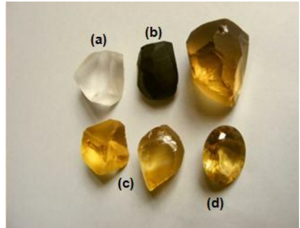
FIGURA 18 - Quartzo “honey” incolor(a), após irradiado (b), irradiado e tratado (c) e lapidado (d).
