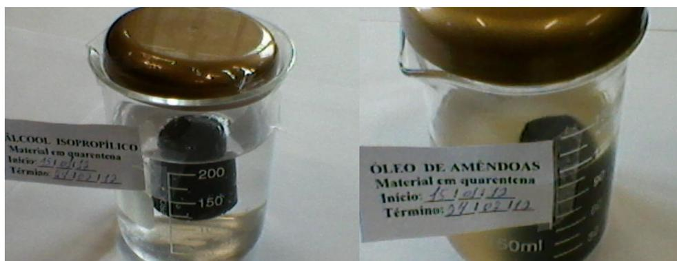
FIGURA 14 - Tampas em PEBD com 1,4% de pigmento de carvão vegetal imersas em soluções de álcool isopropílico e óleo de amêndoas por período de 40 dias
