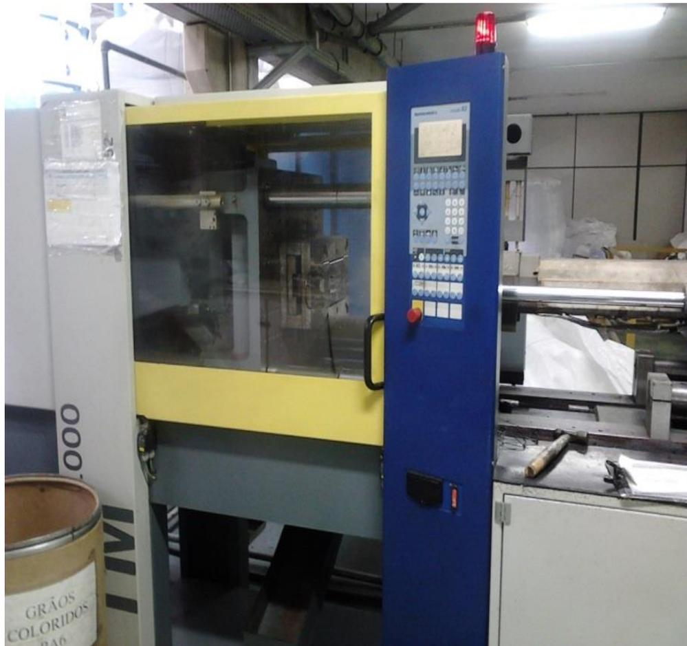
FIGURA 6 - Injetora Batenfeld, modelo TM 1000/525-100 utilizada na injeção dos corpos de prova das amostras estudadas neste trabalho
