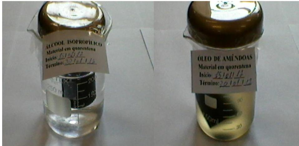
FIGURA 13 - Tampas em PEBD com 1,4% de pigmento de carvão vegetal imersas em soluções de álcool isopropílico e óleo de amêndoas por período de 15 dias
