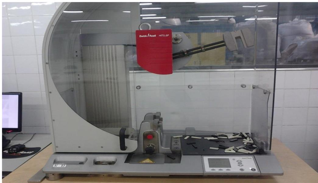
FIGURA 10 - Pêndulo de impacto modelo – Zwick AI 03, de 0,5 a 5,0 joules
