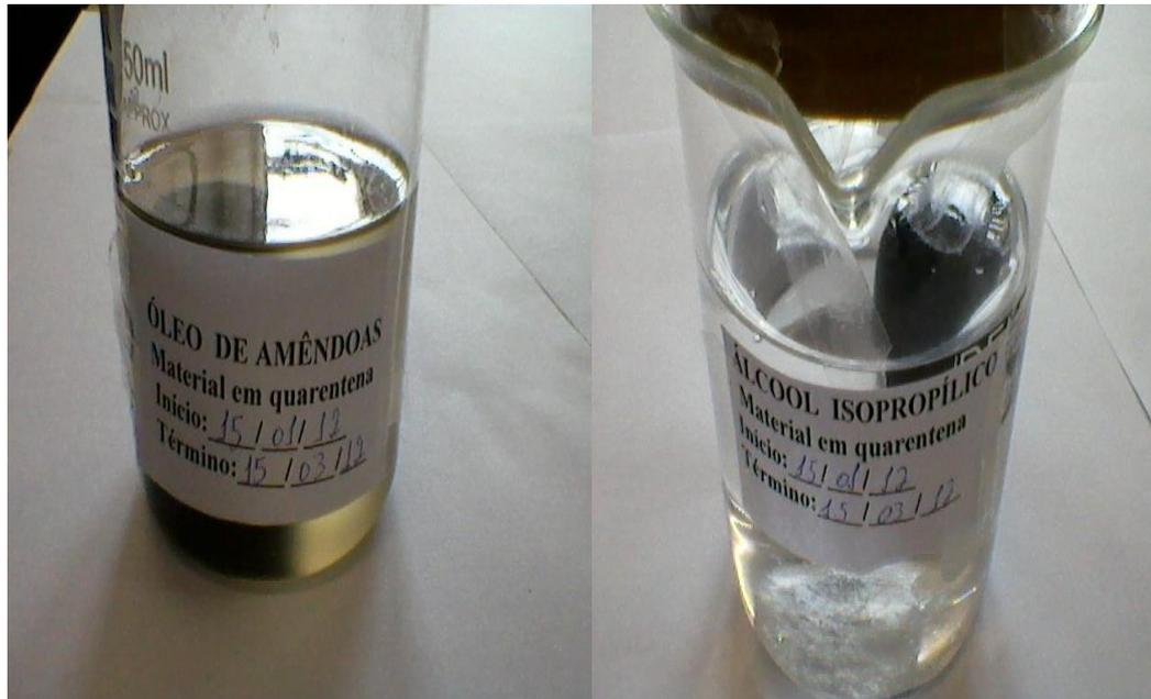
FIGURA 15 - Tampas em PEBD com 1,4% de pigmento de carvão vegetal imersas em soluções de álcool isopropílico e óleo de amêndoas por período de 60 dias.
