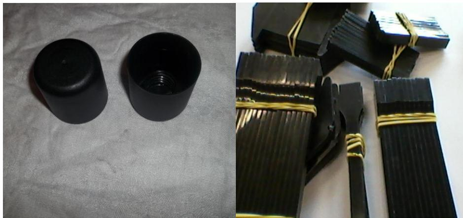
FIGURA 11 - Tampas rosqueáveis e corpos de prova de PEBD contendo 1,4% de pigmento de carvão vegetal, após injeção.
