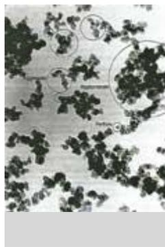
FIGURA 4 - Microscopia eletrônica de varredura do negro de fumo em matriz polimérica.
