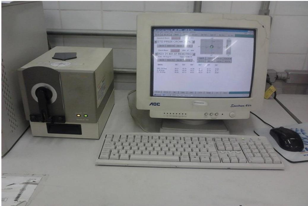
FIGURA 7- Espectrofotômetro utilizado para realização das leituras colorimétricas
