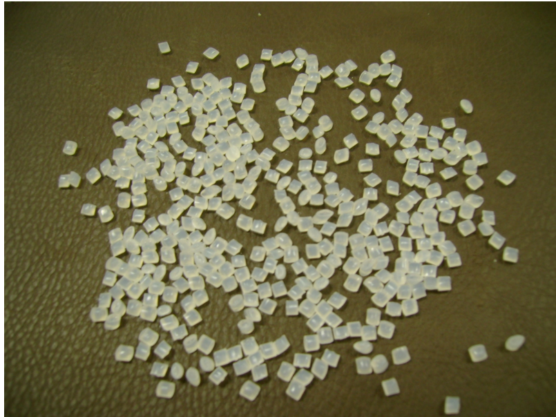
Figura 02. Grânulos de PEBD utilizados na blenda PA 6,6/PEBD Catálogo Informativo Polietileno S/A, 2006.
