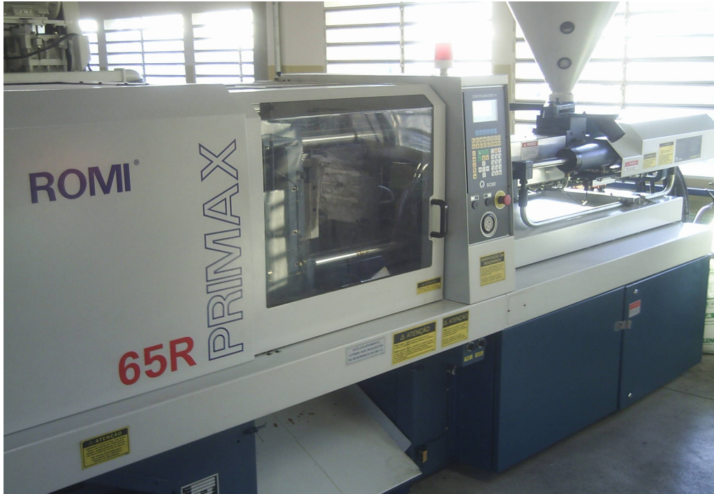
Figura 08 - Máquina Injetora Modelo Primax 65R utilizada para Injeção do corpo de prova da blenda PA6,6/PEBD (75/25%) Fonte: Laboratório de Plásticos da Faculdade de Tecnologia da Zona Leste – FATEC – ZL, São Paulo
