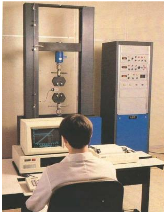
Figura 10 – Dinamômetro, equipamento utilizado na realização de ensaios de Resistência à Tração.
