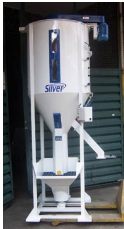
Figura 03 – Misturador vertical utilizado para obtenção da blenda PA6,6/PEBD (75%/25%) Fonte: (Revista Plástico Moderno, setembro/2007)
