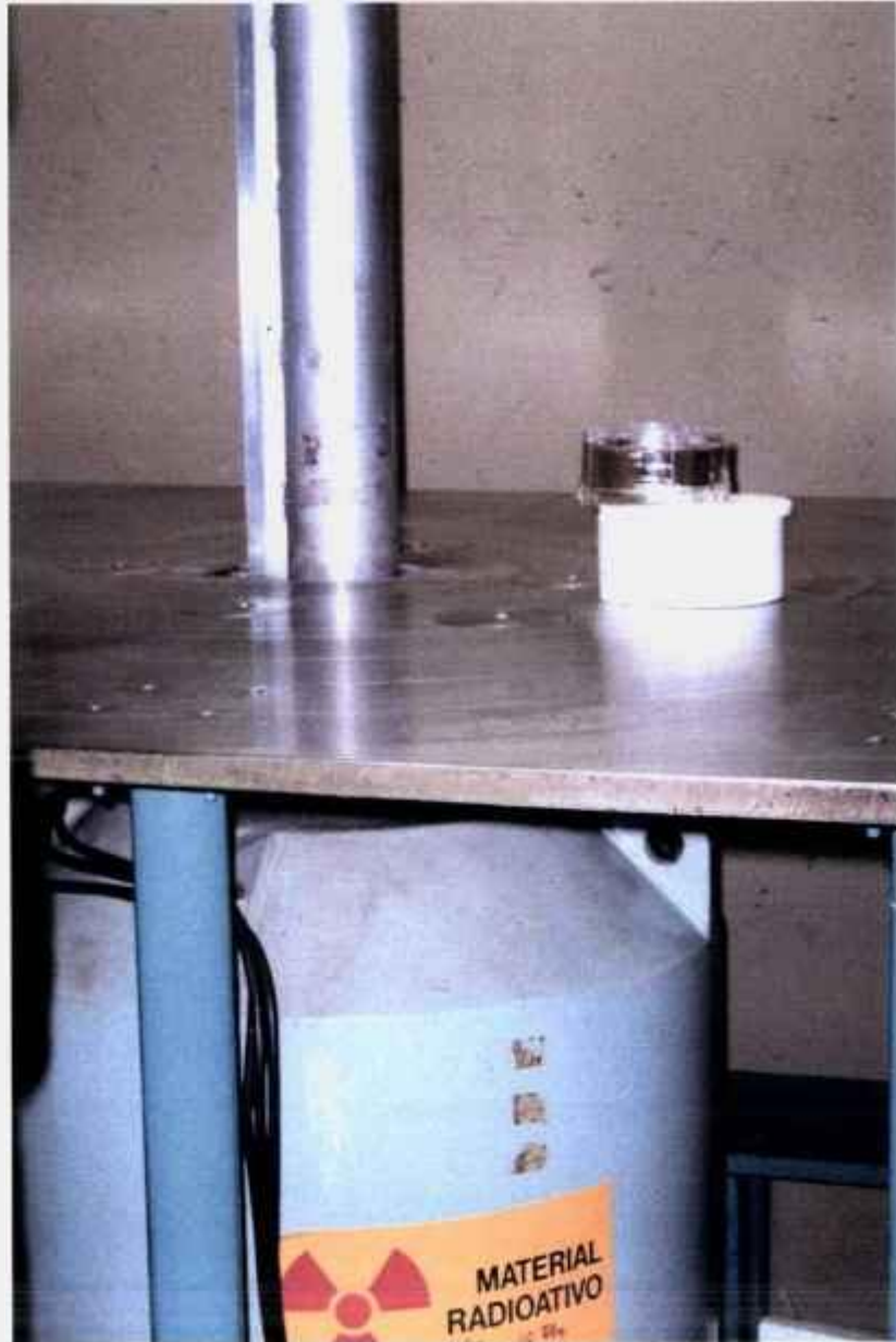
Figura 3. Fonte Panorâmica de Co-60. Pertencente ao CTR / IPEN Centro de Tecnologia das Radiações.
