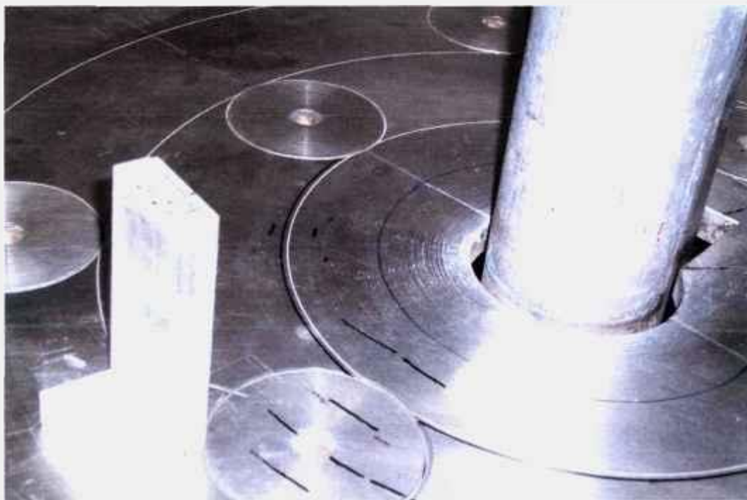
Figura 2. Arranjo experimental para a irradiação dos dosímetros de gel.
