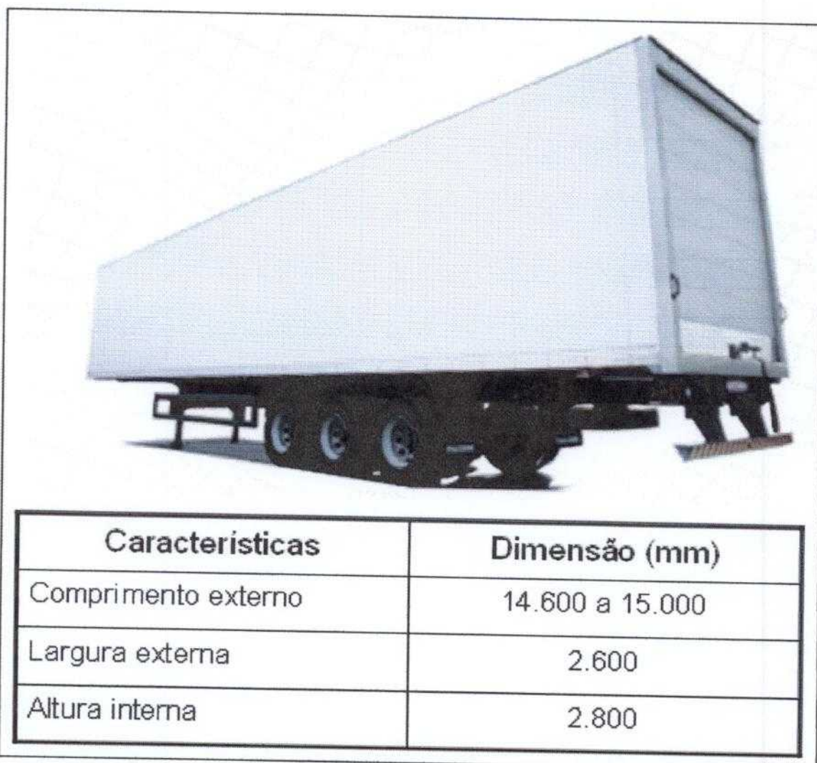
FIGURA 16 – Características e dimensões das carretas fabricadas no país
