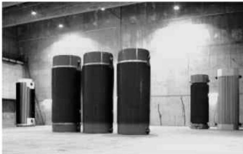
Figura 41 - Cascos metálicos de armazenagem seca de CNQ - Gorleben, Alemanha.
