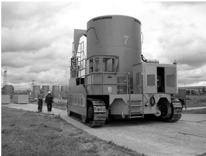
Figura 50 - Transporte do casco de concreto com CNQ, Zaporizhzhya, Ucrânia.
