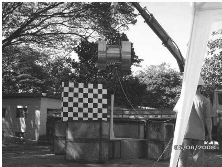
Figura 69 - Teste de queda de 1m de altura de protótipo de casco para CNQ sobre uma barra pontiaguda (Local: Campo de testes CDTN/CNEN-MG) Fonte: Romanato (2008); Foto: Romanato, L.S.
