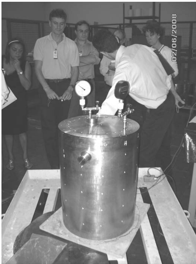
Figura 66 – Montagem alternativa ao teste de estanqueidade de protótipo de casco para CNQ (Local: Campo de testes CDTN/CNEN-MG)
