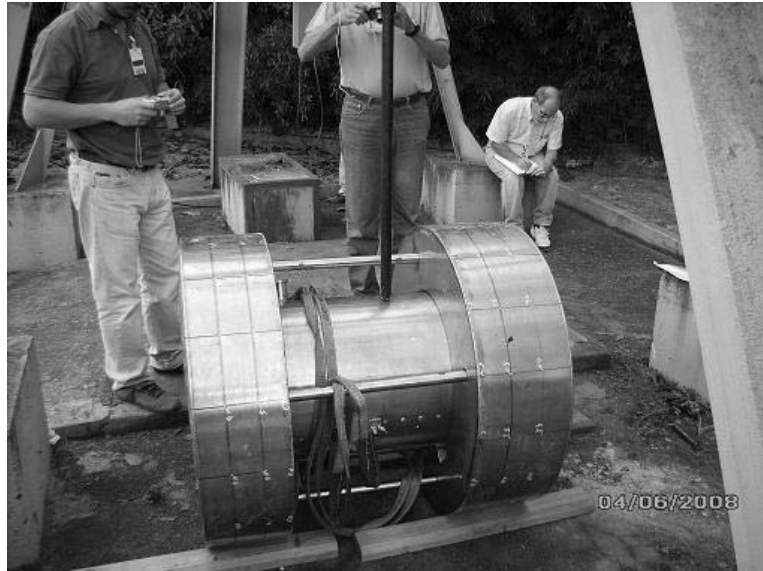
Figura 68 – Teste de queda de barra pontiaguda de uma altura de 1m sobre protótipo de casco para CNQ (Local: Campo de testes CDTN-CNEN/MG) Fonte: Romanato (2008); Foto: Romanato, L. S.
