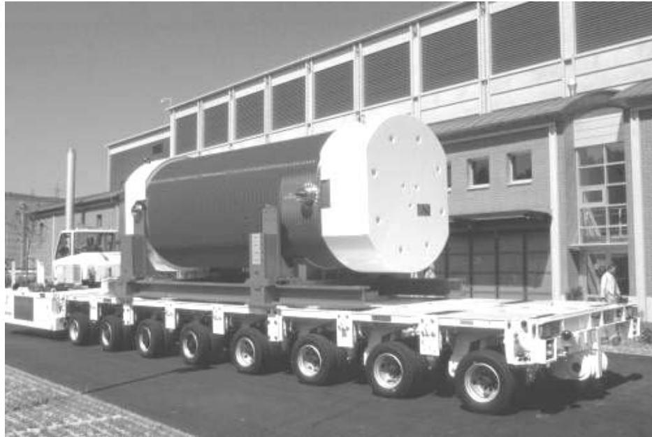
Figura 56 - Transporte rodoviário de casco metálico de CNQ
