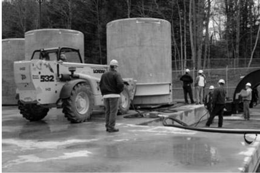
Figura 73 – Exemplo de veículo para a movimentação de cascos com CNQ nas instalações de armazenagem.
