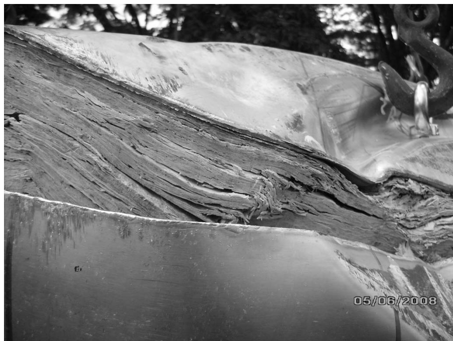
Figura 26 – Detalhe do absorvedor de impacto após impacto resultante da queda de 9m. Fonte: Romanato (2008); Foto: Romanato, L. S.
