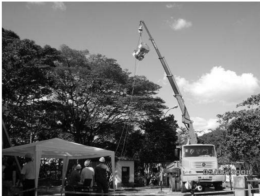
Figura 70 – Teste de queda de 9m de altura de protótipo de casco para CNQ (Local: Campo de testes CDTN/CNEN-MG)
