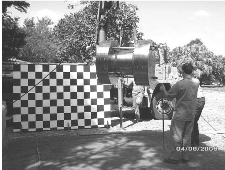
Figura 67 – Teste de queda de 1,2m de altura, de protótipo de casco para CNQ (Local: Campo de testes CDTN/CNEN-MG)
