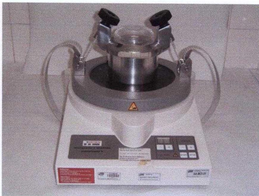
FIGURA 4.9 – Foto do micro moinho *Pulverisette 0* da *Fritsh*.
