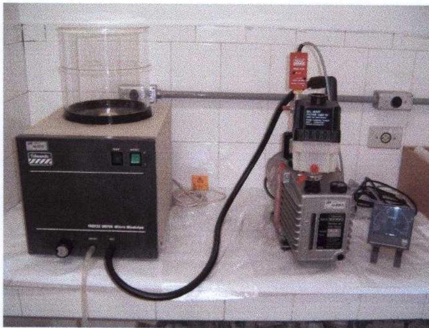
FIGURA 4.8 – Foto do liofilizador *Micro Modulyo* da *Edwards*.
