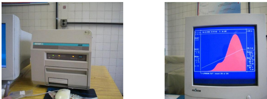
FIGURA 7 - Harshaw Nuclear System e o gráfico da leitura do dosímetro
