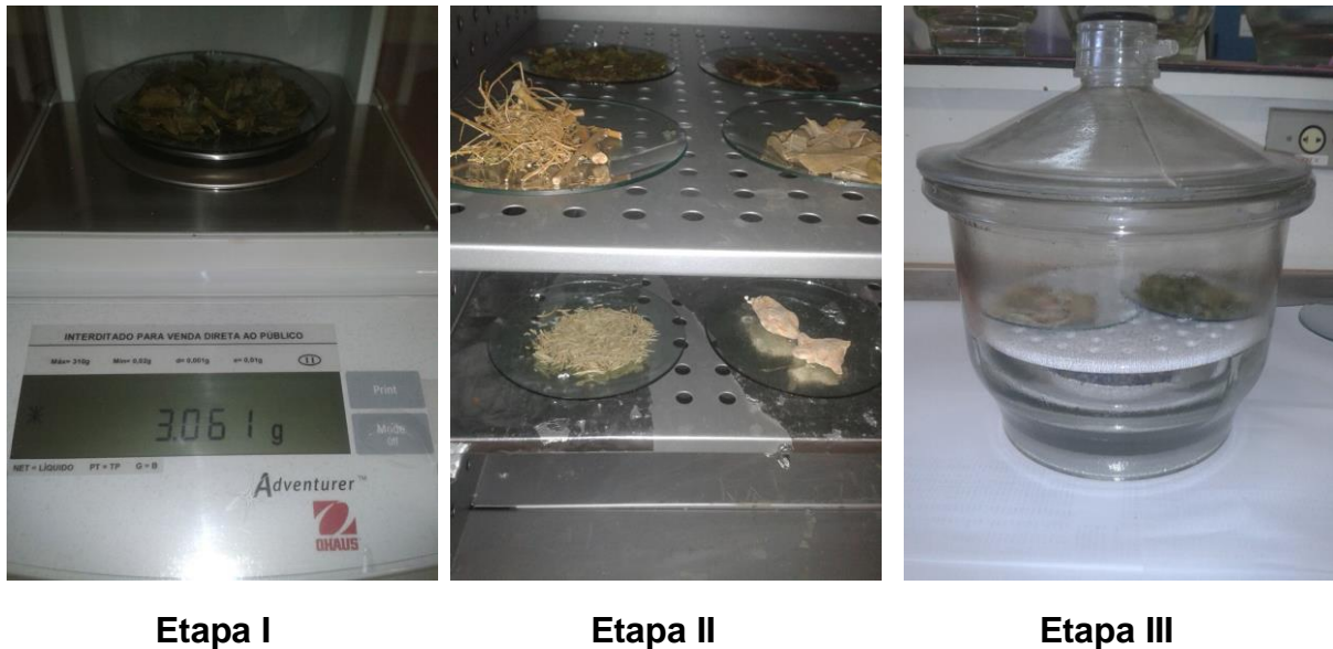
FIGURA 3.2: Ilustração do processo utilizado para determinação do teor de umidade: pesagem (etapa I), secagem (etapa II) e resfriamento da amostra (etapa III).
