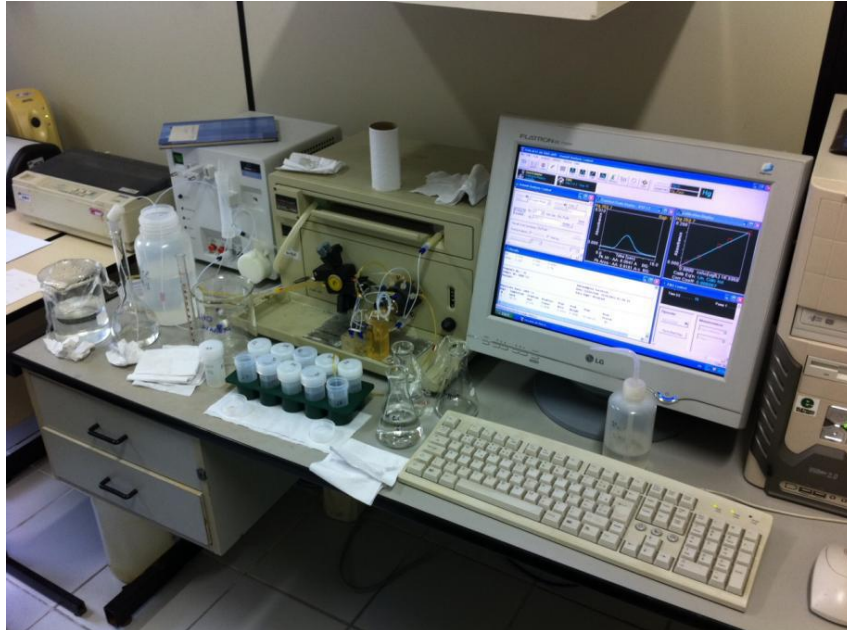
FIGURA 3.12: Equipamento de CV AAS do Laboratório de Absorção Atômica do LAN/IPEN-SP marca Perkin Elmer, modelo FIMS 100 ( Flow Injection Mercury System ) para determinação de Hg.
