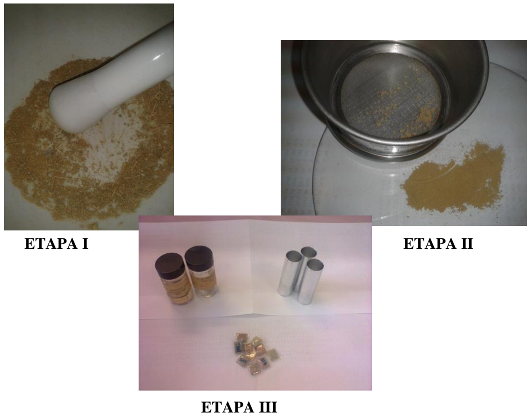
FIGURA 3.6: Ilustração do processo de preparação das amostras de plantas para irradiação: processo de trituração (etapa I), peneiramento e homogeneização da amostra (etapa II) e acondicionamento da amostra em sacos de polietileno para irradiação (Etapa III).
