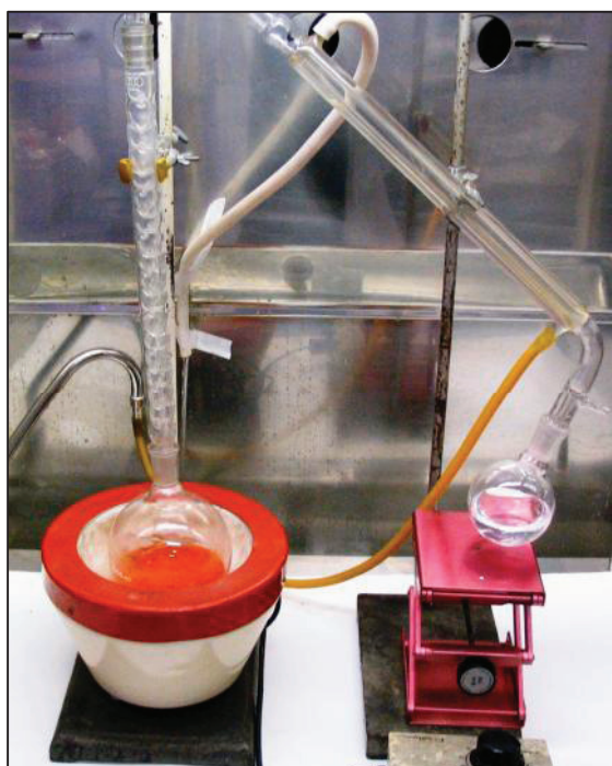
FIGURA 9: Aparato utilizado para destilação dos RRLO
