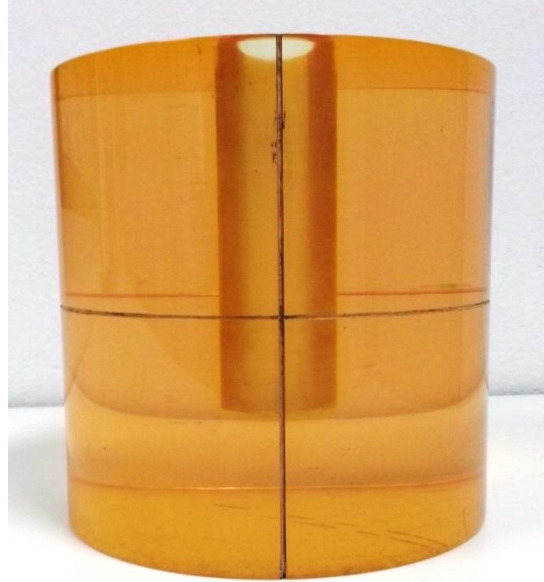
Figura 18- Simulador cilíndrico utilizado na medição da fonte de ^{207}\text{Bi} .
