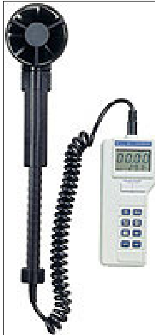
FIGURA 15 – Anemômetro de pás- leitura digital.
