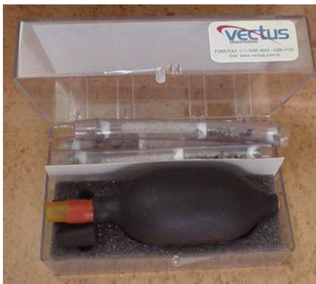
FIGURA 45 - Estojo contendo ampolas de fumaça e pêra.
