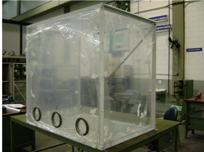
FIGURA 27 - Etapa de montagem da caixa básica.
