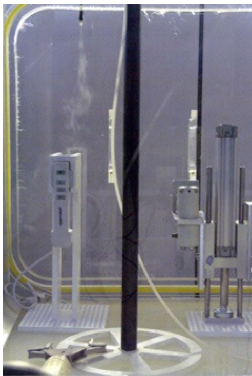
FIGURA 57 – Ensaio de sentido e visualização do fluxo de ar, envolvendo o sistema de dosificação.
