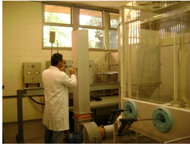
FIGURA 40 – Medição da pressão dinâmica a partir do tubo de Pitot.
