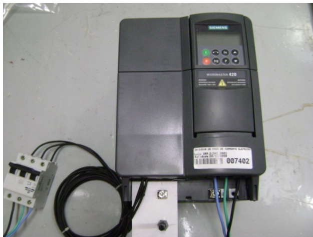
FIGURA 42 - Inversor de frequência utilizado no desenvolvimento.
