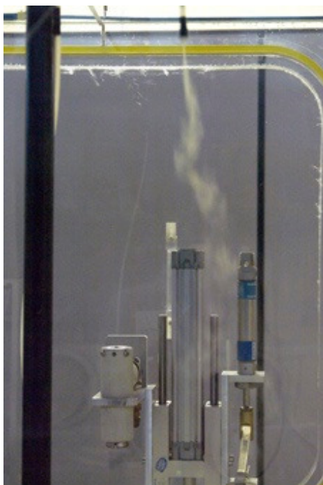
FIGURA 56 – Ensaio de sentido e visualização do fluxo de ar, envolvendo o conjunto lacrador-deslacador.
