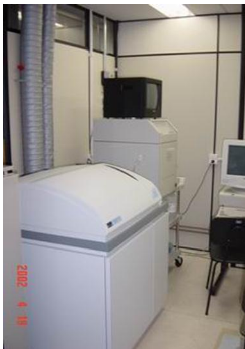
Figura 6.10: Espectrômetro de Massa por plasma - ICP - MS.
