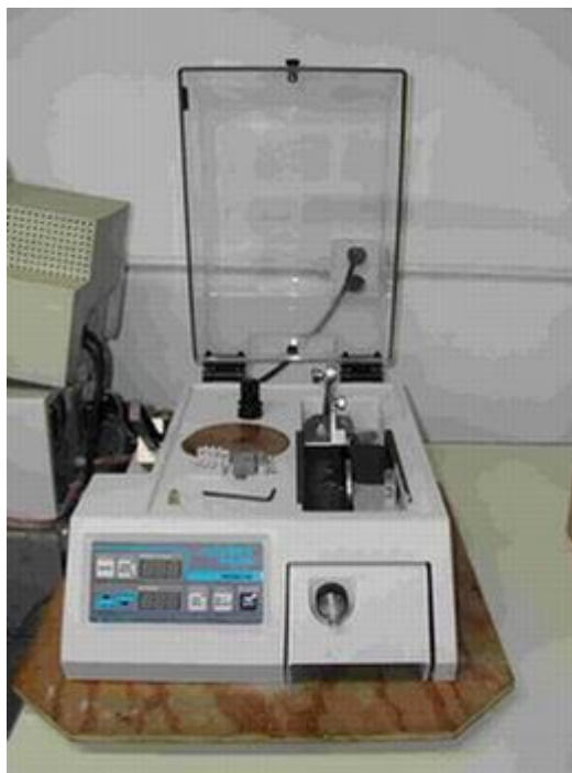
Figura 6.9: Cortadora de precisão ISOMET 1000, BUEHLER .
