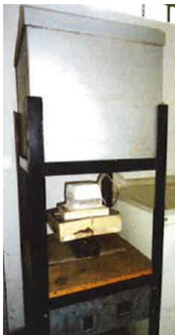
Figura 6.7: Forno para recozimento (Temperaturas até 1200 °C).
