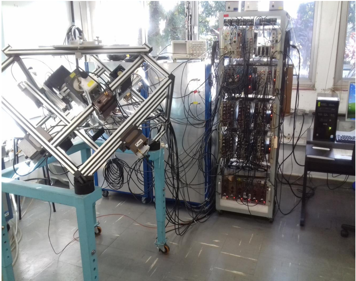
Figura 3.14 – Vista geral do espectrômetro de CAP constituído por seis detectores instalado no LIH.
