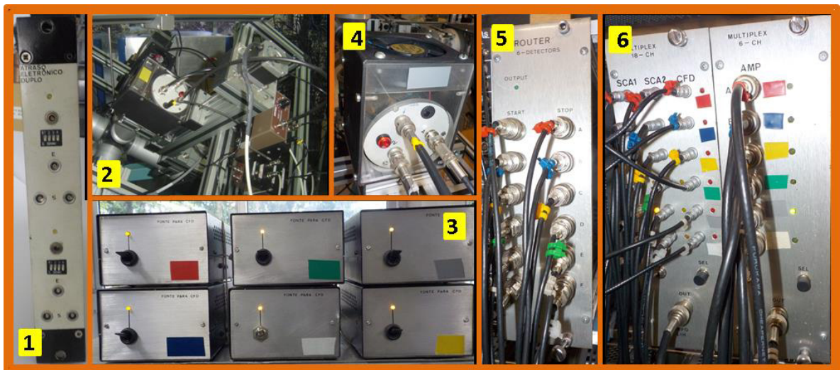
Figura 3.32 – Unidades complementares desenvolvidas no LIH para o espectrômetro de CAP seis detectores: (1) módulo de atraso digital; (2) circuito de posicionamento para detectores; (3) fontes de alimentação para CFDs; (4) divisor de tensão para válvula fotomultiplicadora; (5) roteador; (6) multiplexador analógico. As cores das fitas representam os detectores e seus ramos: vermelha (A), azul (B), amarelo (C), verde (D), cinza (E) e branco (F).
