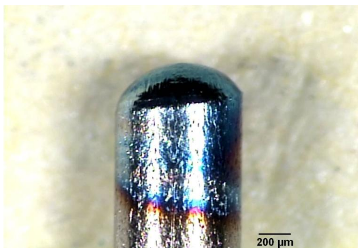
FIGURA 66 - Solda com vazão de gás em excesso apresentando oxidação na superfície (Q=8 L/min)
