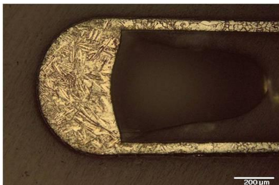
FIGURA 85 - Microscopia óptica da seção longitudinal da segunda solda no tubo de titânio
