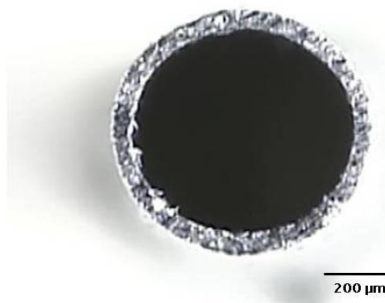
FIGURA 44 - Tubo de titânio após ser desbastado com lixa grana 400
