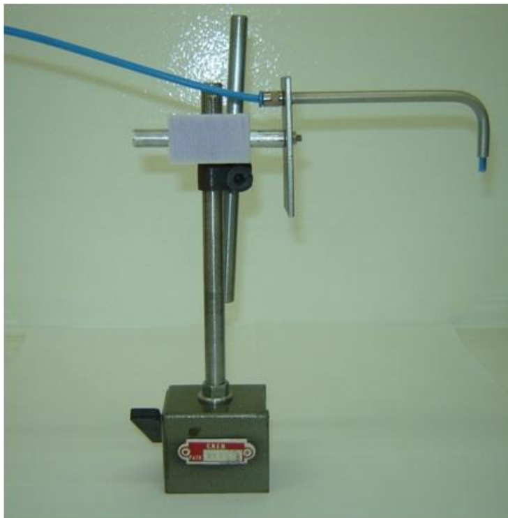
FIGURA 27 - Bocal de gás de proteção com tubo de aço inoxidável AISI 304 curvado em 90° na saída do gás
