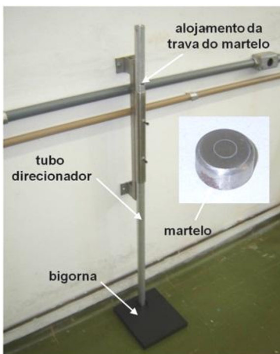
FIGURA 41 - Dispositivo de impacto e martelo utilizado no ensaio das sementes de iodo-125
