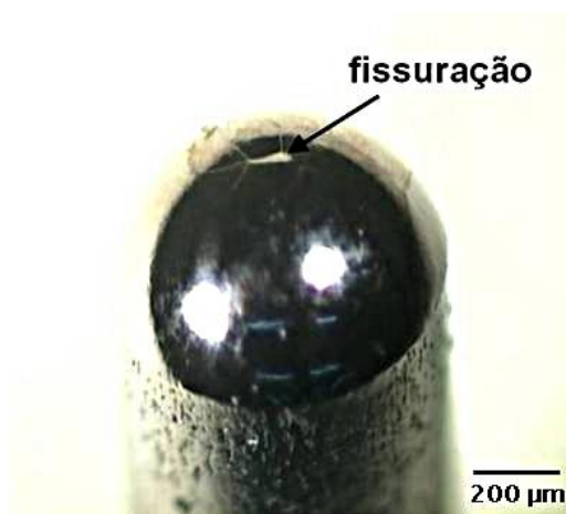
FIGURA 72 - Região soldada apresentando fissuração
