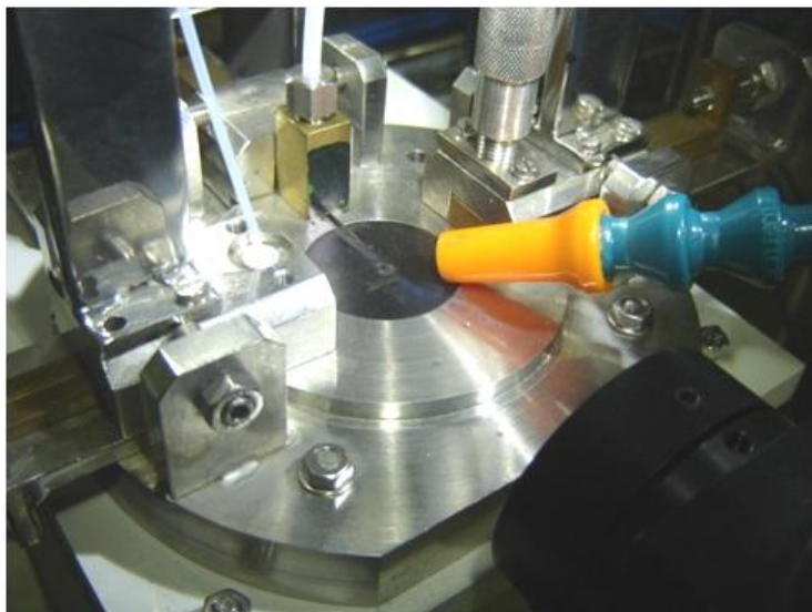
FIGURA 25 - Bocal de gás de proteção com tubos flexíveis
