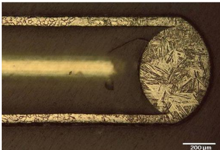
FIGURA 84 - Microscopia óptica da seção longitudinal da primeira solda no tubo de titânio
