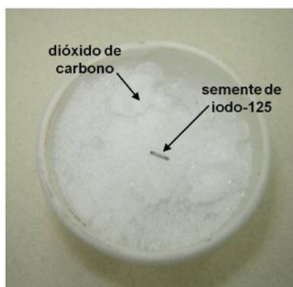
FIGURA 38 - Ensaio de baixa temperatura em uma semente de iodo-125
