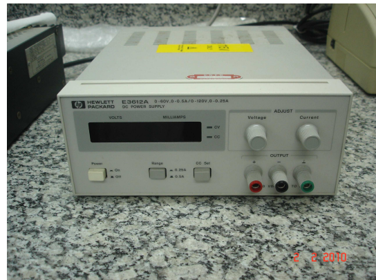
FIGURA 16 – Fonte estabilizada utilizada na cuba de eletrodeposição.
