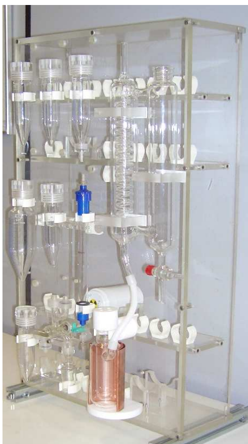
FIGURA 43 - Montagem do Módulo, fixação das abraçadeiras de PVC e dos reservatórios.
