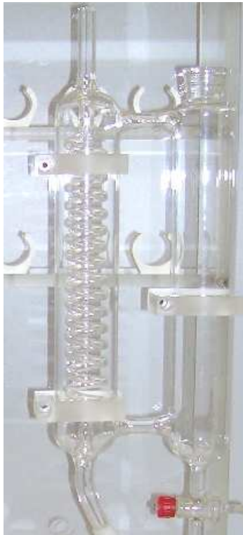
FIGURA 49 - Condensador para condensar o vapor de água do concentrador.
