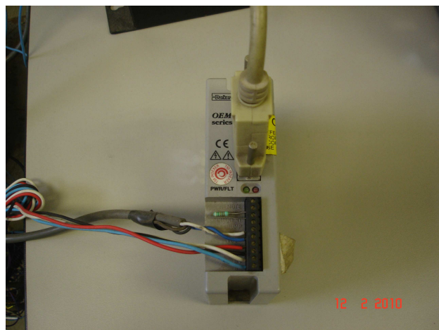
FIGURA 25 - "Drive" de programação e controle do motor de passo do sistema de pipetagem e lacração e da cuba de dissolução
