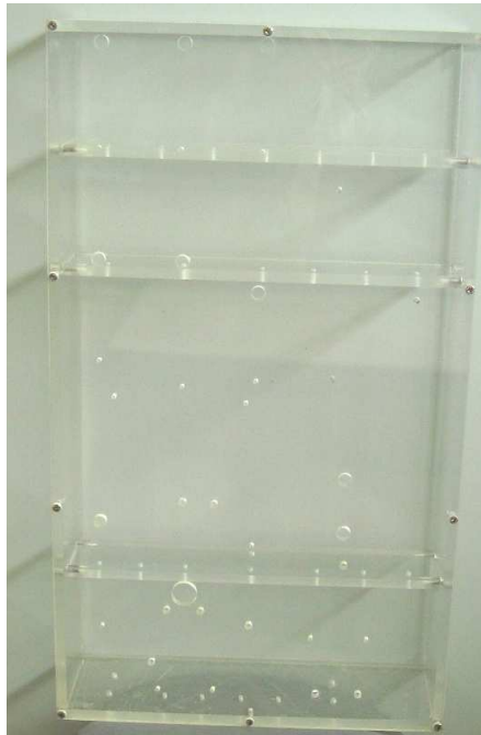
FIGURA 41 - Placas montadas dando forma ao módulo de processamento ^{67}\text{Ga} .
