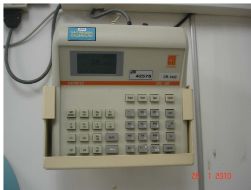
FIGURA 35 - Painel de operação e leitura das medidas radioativas do calibrador de dose.
