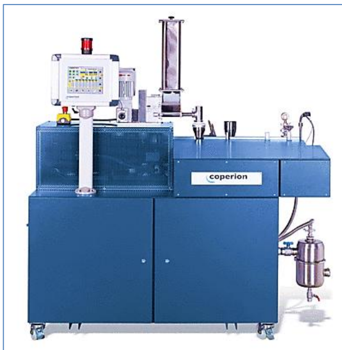
Figura 16 - Extrusora dupla rosca (ZSK 18 Megalab).
