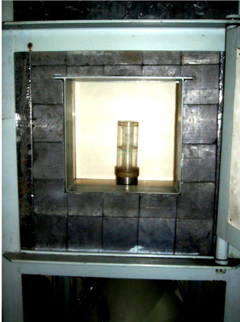
**FIGURA 3.3:** fotografia do sistema de medidas do HPGe. No centro o suporte de lucite localizado sobre o detector HPGe sob o qual é colocado a fonte. Ao redor uma reforçada blindagem de chumbo.
