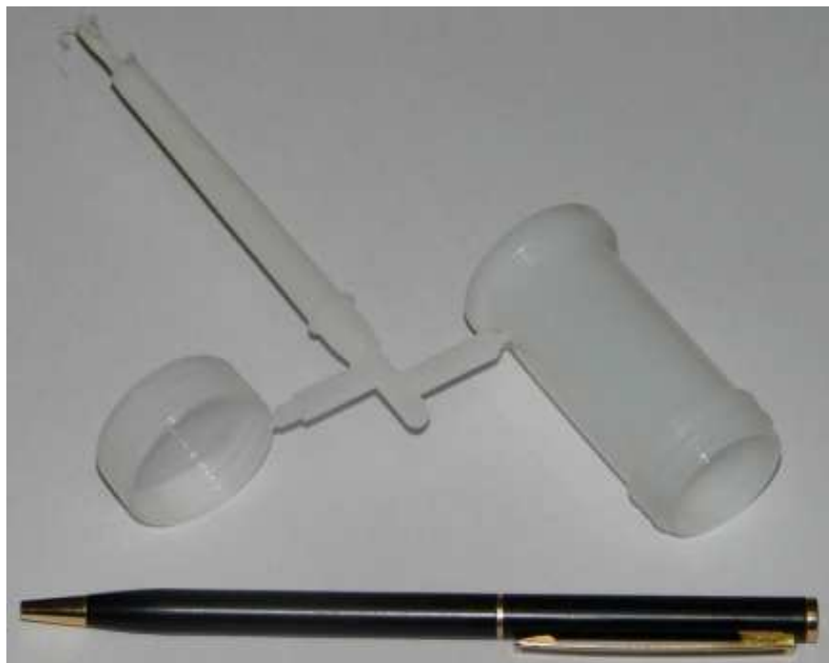
FIGURA 4.12 (a) – Características de Fabricação (Injeção Plástica) Porta Amostras do Antigo PTS
