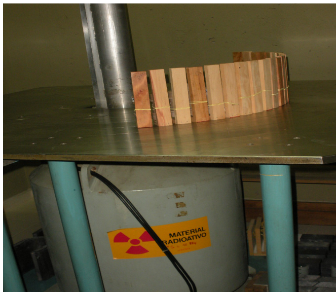
Figura 1: Fonte Panorâmica de Cobalto 60 ( ^{60}\text{Co} )
