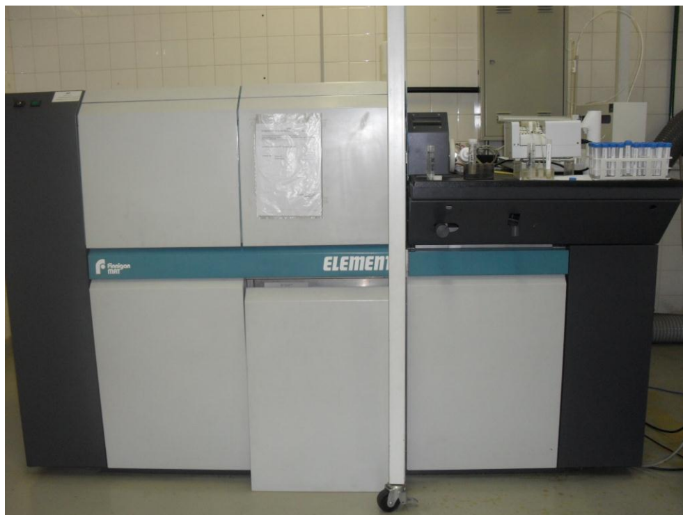
FIGURA 17 – Espectrômetro de massas Finnigan MAT, ELEMENT, (Bremen, Germany) com fonte de Plasma Indutivamente Acoplado (ICP-MS) (SOUSA SILVA, L., acervo pessoal 2010).
