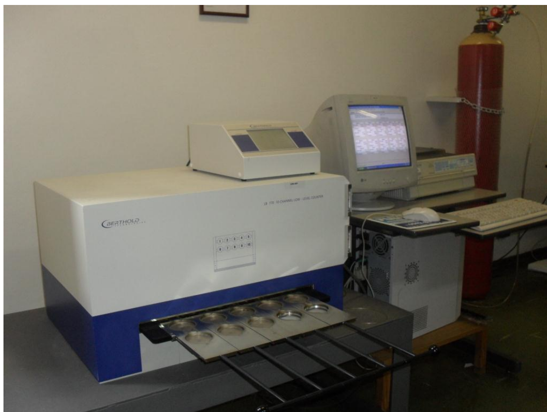
FIGURA 15 – Detector 1 - Detector proporcional de baixa radiação de fundo e fluxo gasoso Berthold LB 770-PC 10 câmaras contadoras com as gavetas abertas para colocação das amostras (LRA – GMR) (SOUSA SILVA, L., acervo pessoal, 2010).
