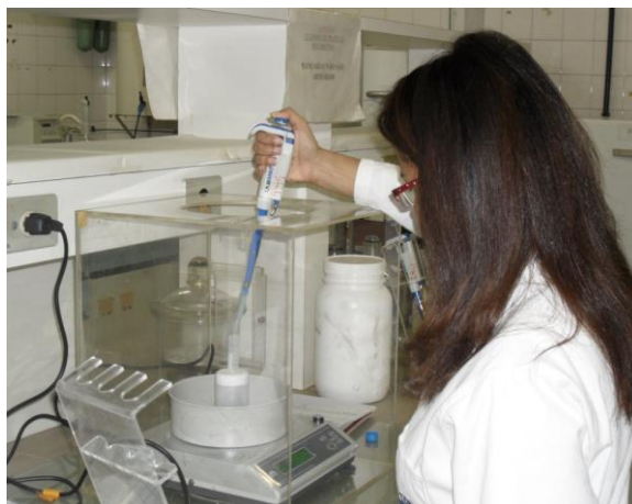
FIGURA 16 – Preparo das soluções padrão de calibração para o ICP-MS (SOUSA SILVA, L., acervo pessoal 2010).
