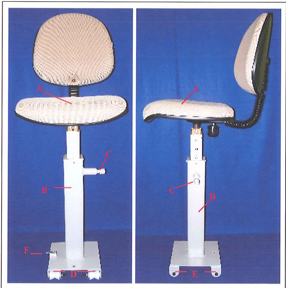
Figura 10. Coluna de ajuste do assento: A) Assento; B) Coluna de ajuste; C) Pino de travamento da coluna de ajuste; D) Rodas; E) Suportes para as rodas; F) Ponteiro da escala.
