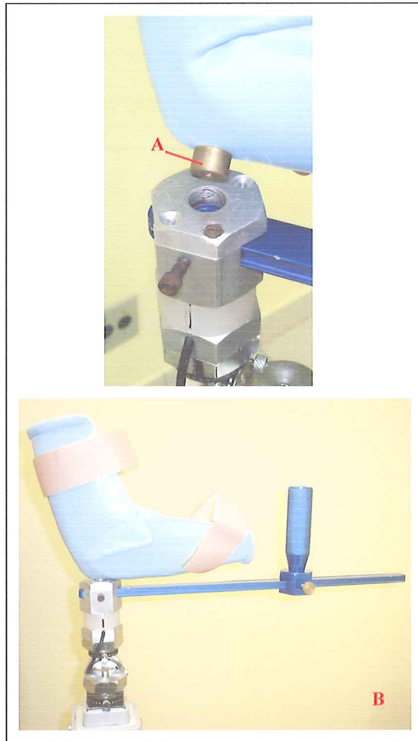
Figura 19. Fixação do sistema de estabilização no torquímetro: A) Pino de fixação do sistema de estabilização no torquímetro; B) Sistema de estabilização fixado sobre o torquímetro.
