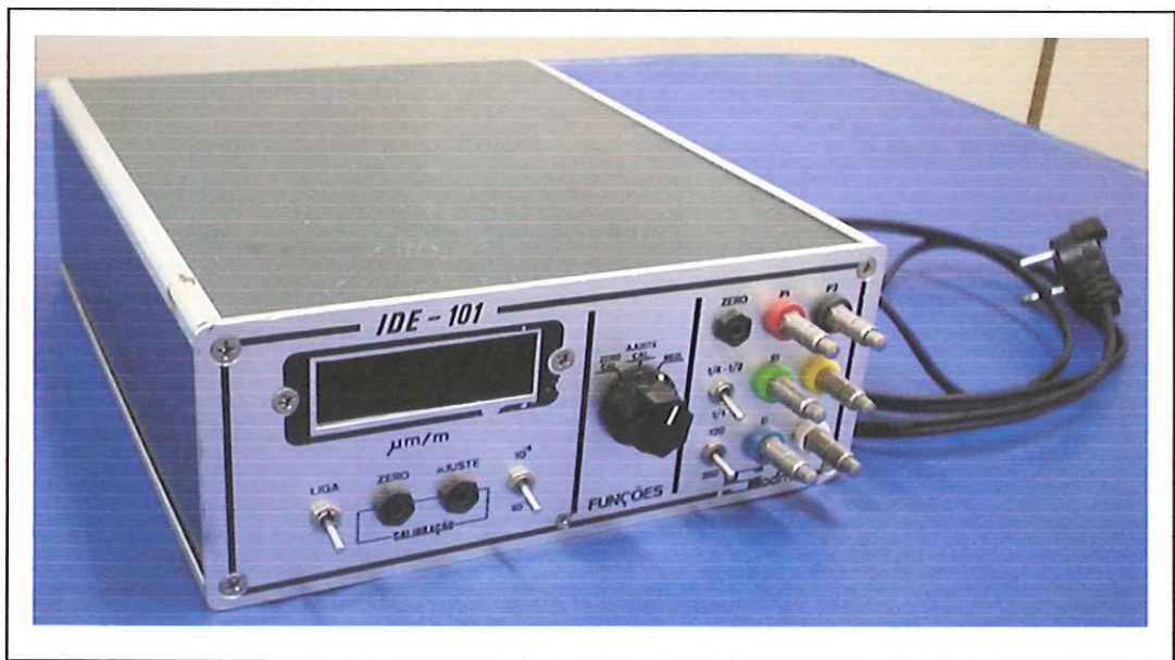
Figura 20. Ponte de extensometria Sodemex ® utilizada durante o trabalho para calibração do torquímetro e coleta das medidas.
