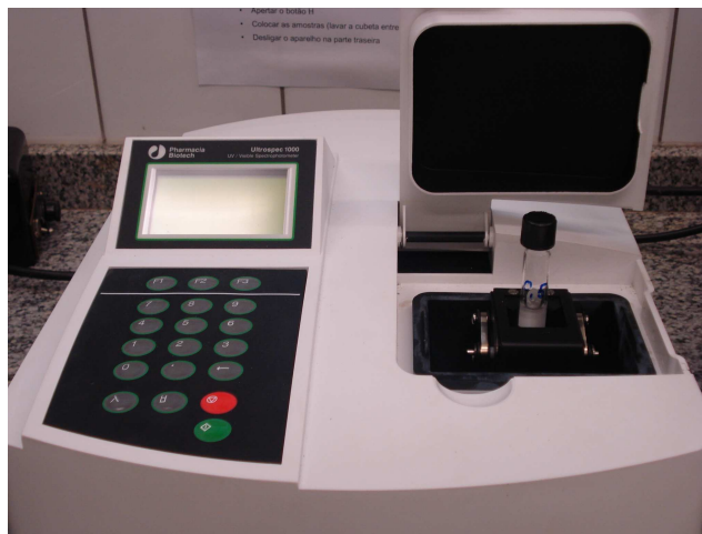
Figura 8: Espectrofotômetro e utilização do tubo da escala 0,5 de MacFarland para padronização dos inoculos bacterianos utilizados.
