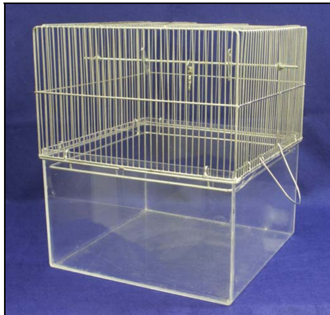
Figura 02. Vista do conjunto composto pelas caixas de acrílico e metálica, encaixadas pelas aberturas e, formando o compartimento de contenção.
