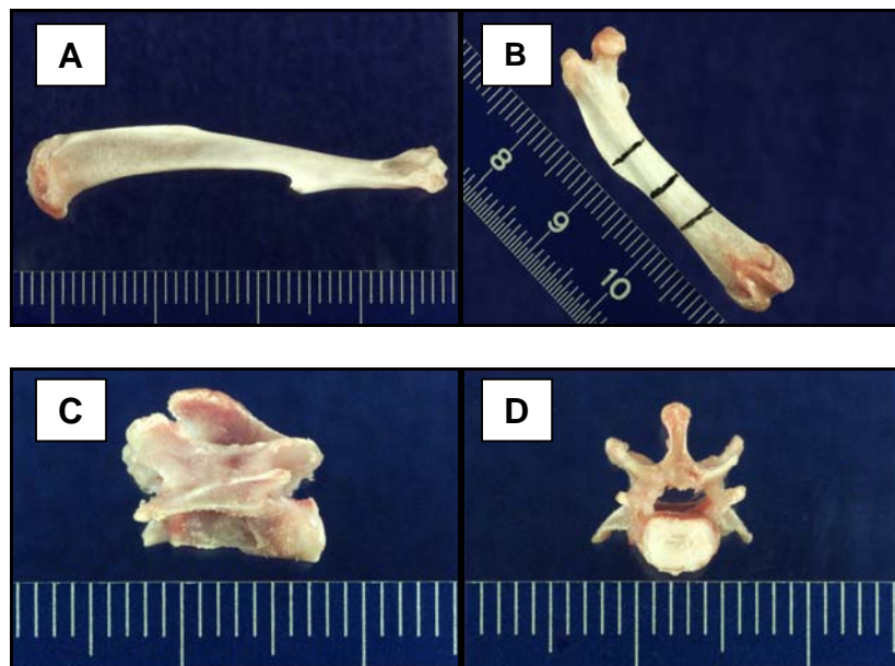
Figura 09. Ossos que foram submetidos ao ensaio mecânico. (A) Tíbia direita dissecada; (B) Fêmur direito dissecado; (C) Vértebra dissecada na vista lateral e (D) anterior.
