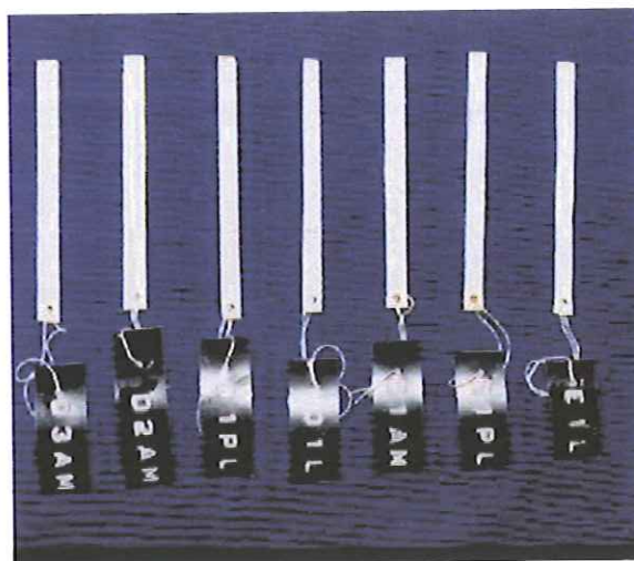
FIGURA 14 – CDPs prontos para o ensaio, medindo 2x4x50 mm.
