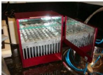
Figura 7- Sistema de LEDs vermelhos para irradiação celular em placas (630 ± 10 nm).
