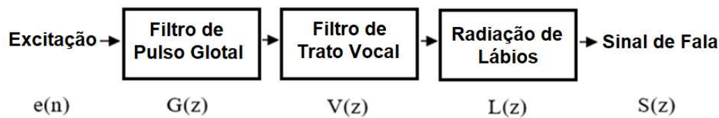
Figura 6 - Modelo linear para a produção da fala da teoria linear de Fonte-Filtro
