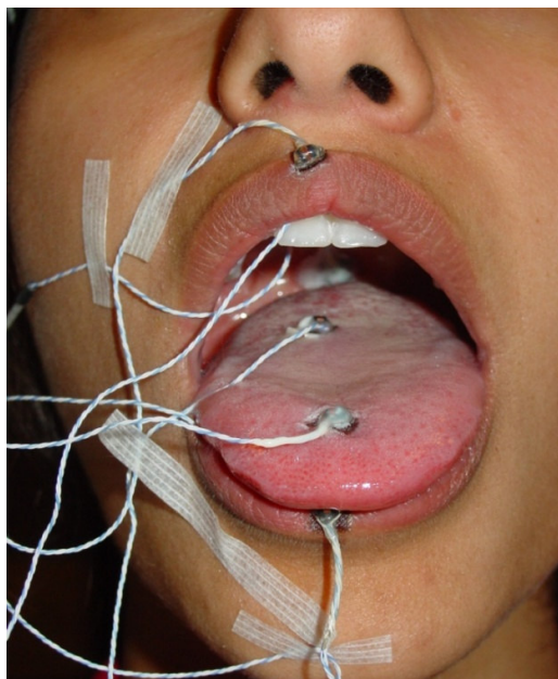
Foto 4: Ilustração do posicionamento dos principais sensores para a coleta dos dados de EMA. Informante RT. Na foto pode se ver cinco sensores: lábios superior e inferior, ponta e lâmina da língua e véu.
