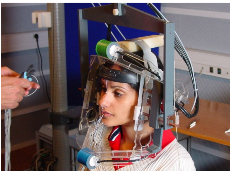
Foto 3: Ilustração da aparelhagem (capacete e transdutores) utilizada para a coleta de dados de EMA no Gipsa-Lab. Informante RT (autora da dissertação).
