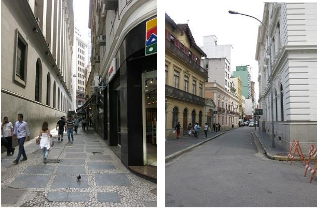
O traçado original da cidade, com ruas estreitas e marcadas pelo acompanhamento das curvas de nível. Nota-se a leve inclinação, sempre, em direção às várzeas, método de escoamento de água e limpeza natural da cidade. Imagens do autor, São Paulo, 2015.
