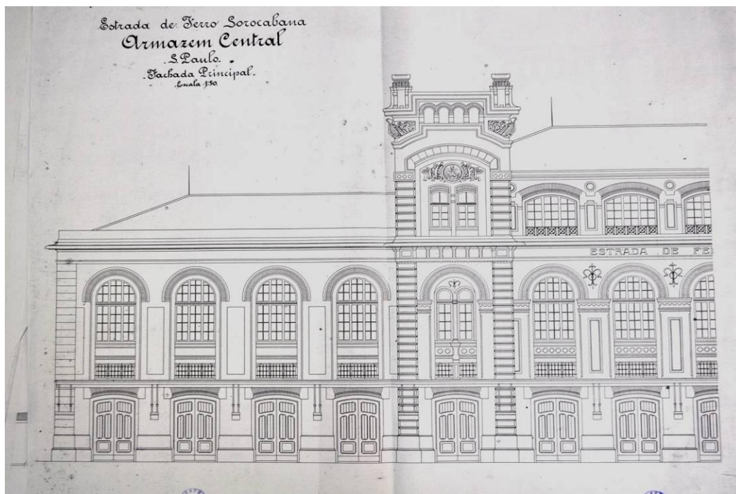
Figura 26 - Parte da fachada frontal do Edifício, cujo desenho foi cedido ao CONDEPHAAT pelo Escritório Técnico Severo & Villares na déc. 1980. Note-se que no desenho há um pavimento a menos que o executado. Foto: Deborah Neves
