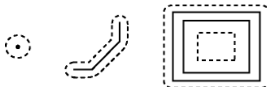
Figura 53. Relações espaciais métricas de distância ( bufferização ) operadas nas primitivas gráficas de ponto , linha e polígono . Neste tipo de relação, são geradas bandas (áreas) ao redor das primitivas selecionadas para a operação. Fonte: Oracle Spatial. Disponível em: http://www.oracle.com/technology/documentation/spatial.html
