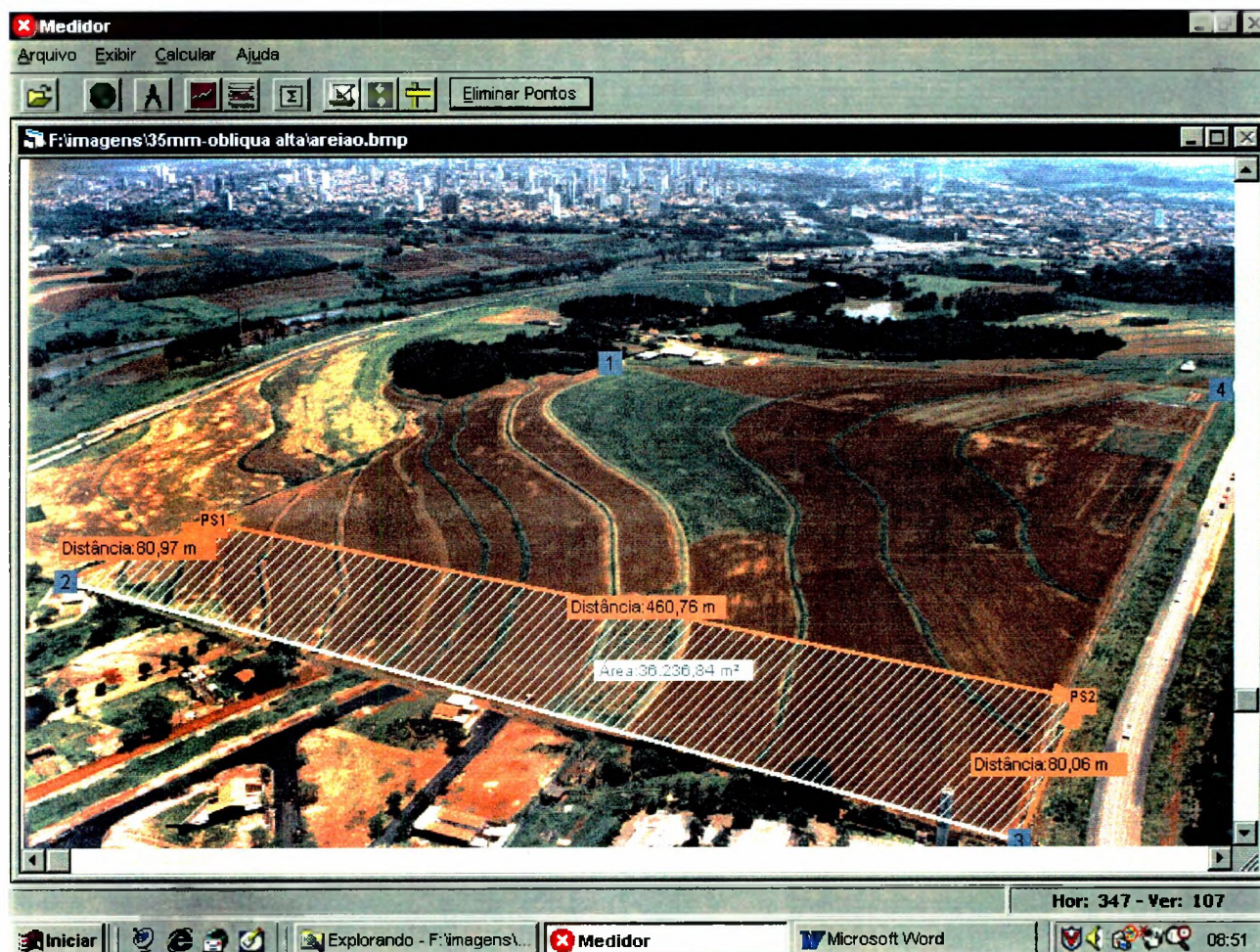
Figura 45. Divisão de áreas através de uma paralela a um lado da propriedade, sobre fotografia aérea formato 35mm, alto-oblíqua. ( Fonte: J.Raffo.2000)
