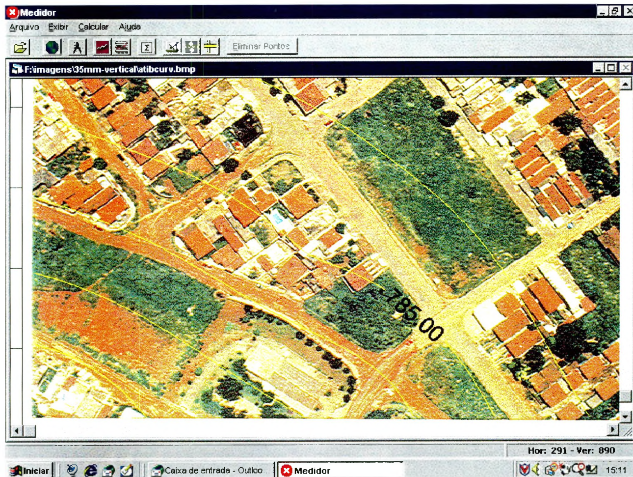
Figura 42 - Desenho de curvas de nível sobre fotografia aérea vertical , formato 35mm. ( Fonte: J.Raffo.2000)
