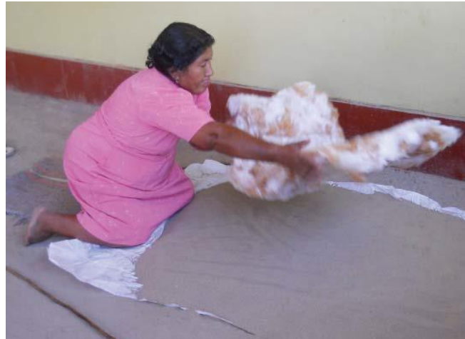
Figura 13 – acomodação de mistura de algodão para formação do rolo– Peru. Fonte: ARBILDO e IPARRAGUIRRE, 2012.
