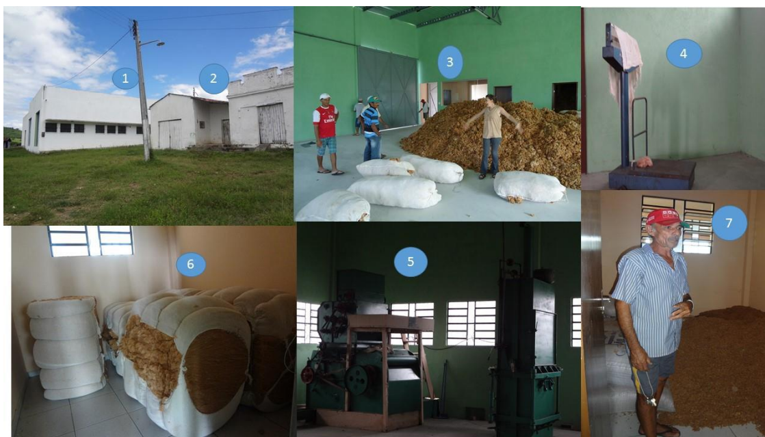
Figura 45 – Mini-usina de beneficiamento de algodão do assentamento Margarida Maria Alves 1 – Forma geográfica que abriga a mini usina de beneficiamento de algodão; 2 – Forma geográfica do antigo local onde era armazenado o algodão branco; 3 – algodão em caroço para ser beneficiado; 4 – balança; 5 – Mini usina; 6 – Fardos de Algodão Rubi; 7 – Agricultor mostrando o local onde ficam armazenado as sementes.
