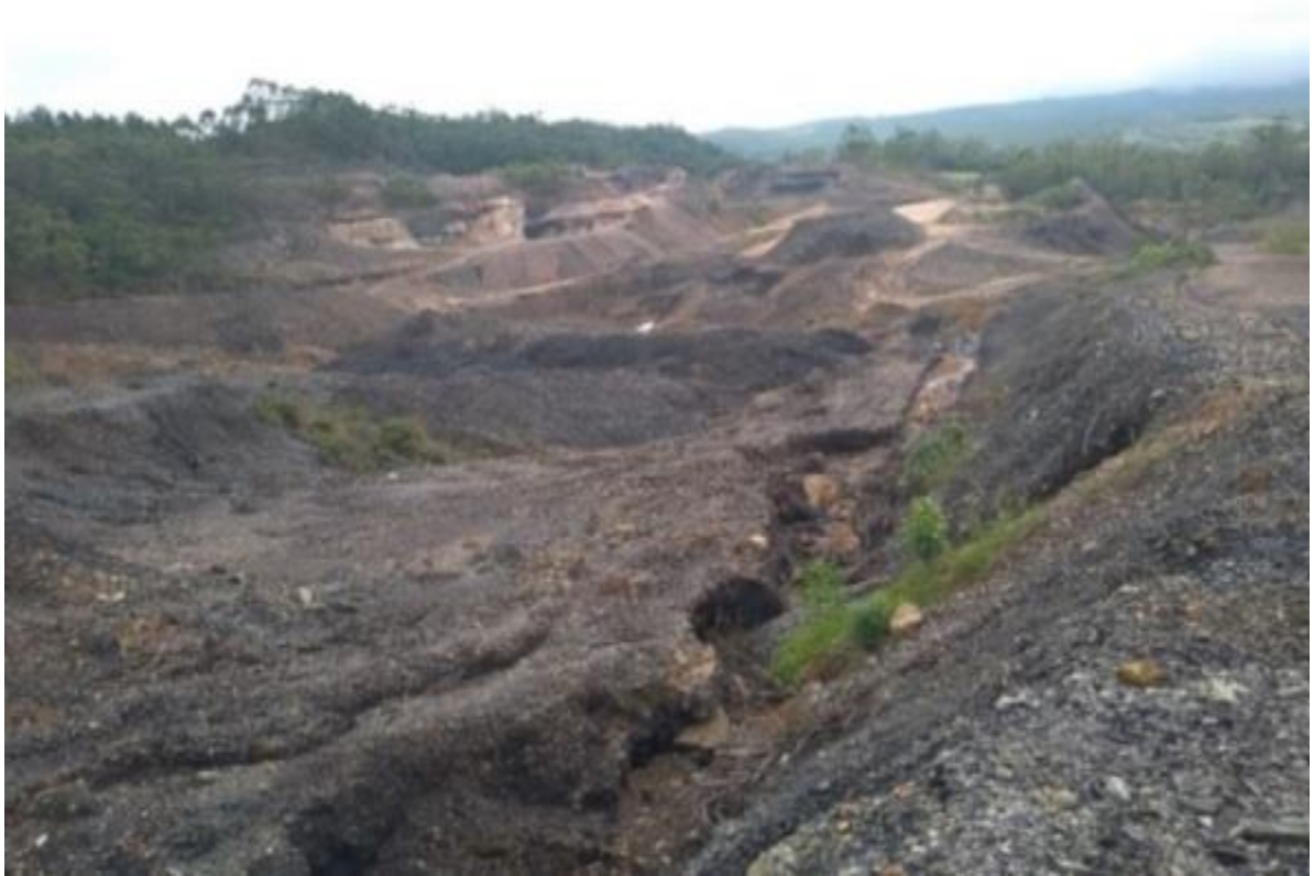
Figura 22- Rejeitos de carvão com erosão generalizada- Urussanga
