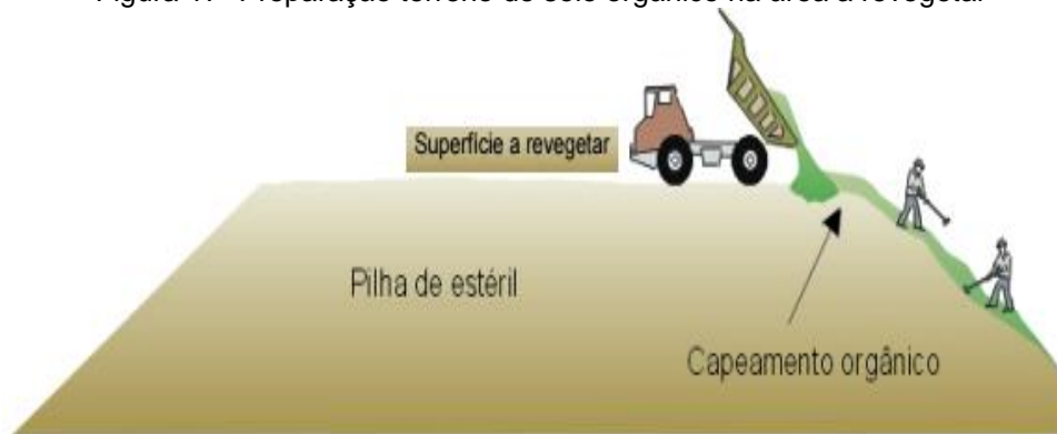
Figura 17- Preparação terreno de solo orgânico na área a revegetar
