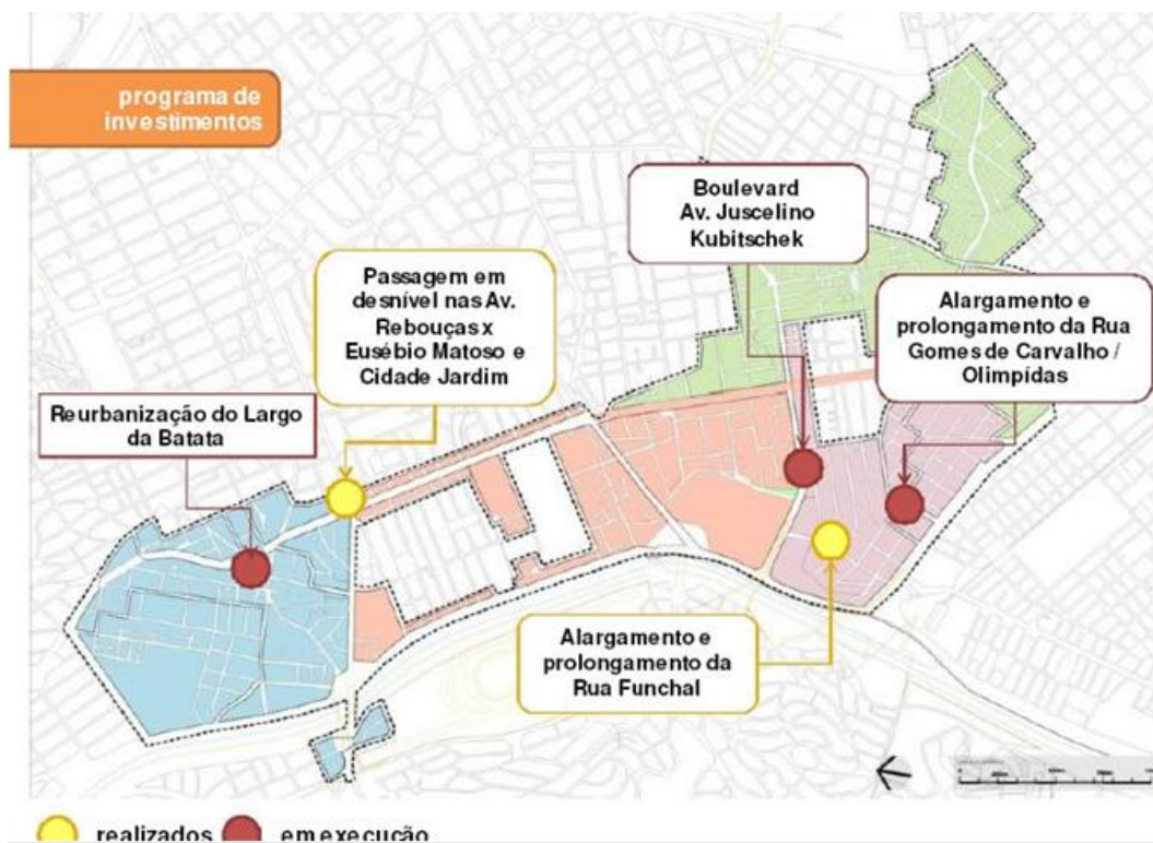
Figura 1.11. Obras na área de intervenção da Operação Urbana Faria Lima
